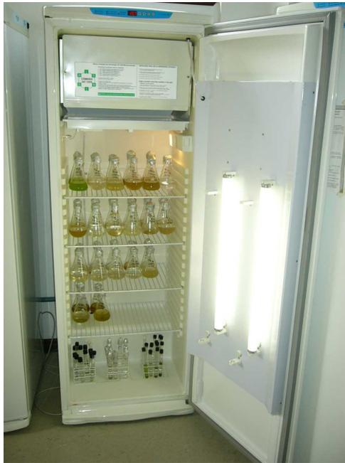
**Figura 4** - Foto ilustrativa da câmara ambiente para germinação (modelo 347-CDG, Fanem).
