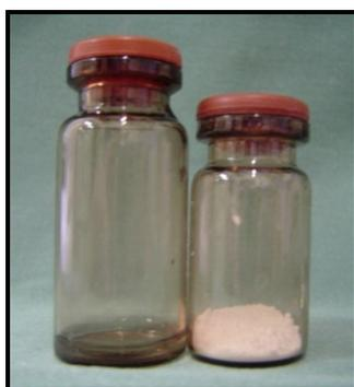
**Fig. 4.** Solução aceleradora e pó do cimento  $\alpha$ -TCP.
