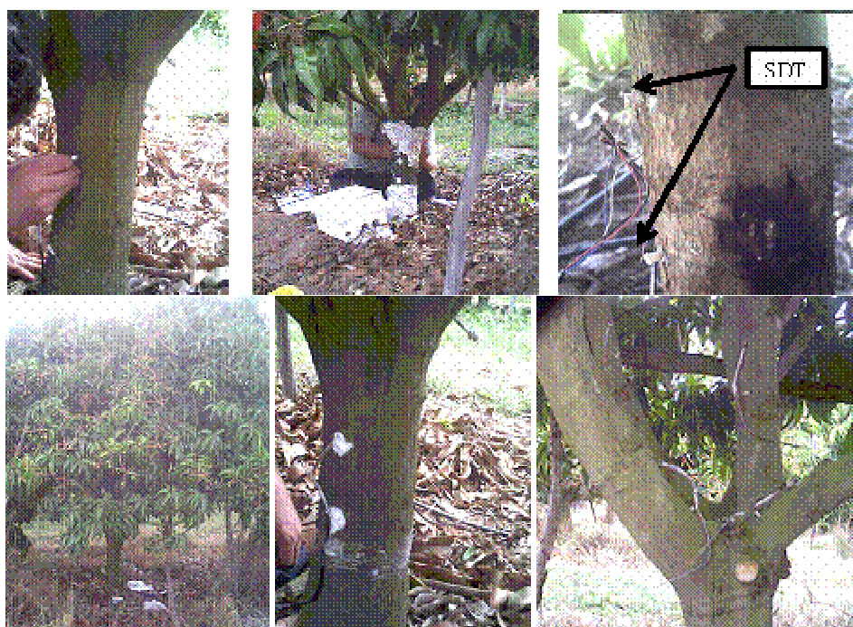
Figura 2. Instalação de uma sonda de dissipação térmica (SDT) em um tronco e ramos de planta adulta.
