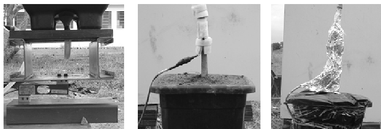
Figura 2. Plataforma de pesagem de 45kg e instalação de um sensor de balanço de calor caulinar
