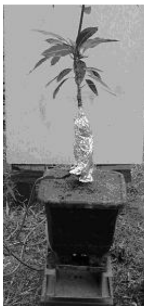
Figura 7. Medida de fluxo de seiva (Granier) e transpiração (lisímetros de pesagem).
