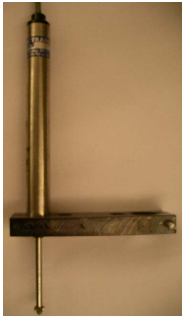
Figura 3.16 – Transdutor de deslocamento linear, LVDT.
