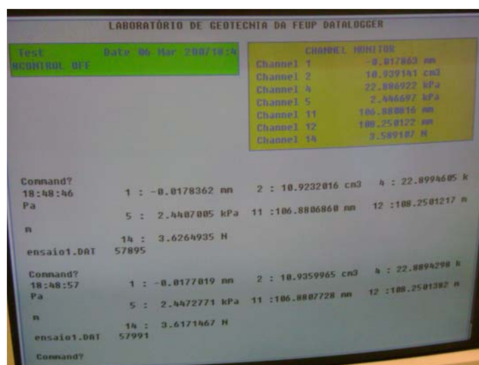
Figura 3.18 – Programa Triax (aquisição e monitoramento de dados de ensaio)
