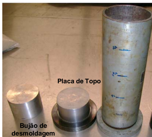
Figura 3.9 – Molde com placas de base e topo e bujão de desmoldagem.
