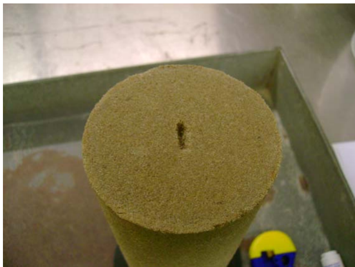
Figura 3.19 – Sulco para introdução dos bender elements .
