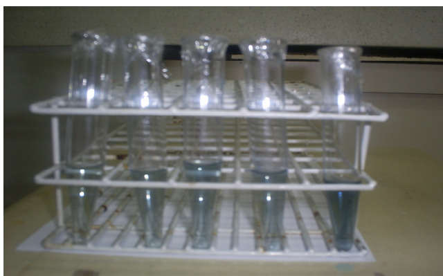
FIGURA 22 - TUBOS DE ENSAIO COM EXTRATOS NO DOSEAMENTO DE POLIFENÓIS FONTE: O AUTOR, 2006.
