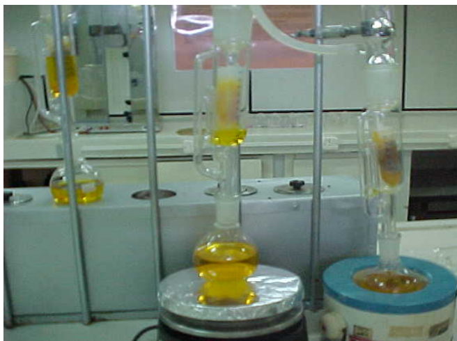
FIGURA 23 - PREPARO DO EXTRATO DE Agaricus brasiliensis EM EXTRATOR SOXHLET ANALITICO FONTE: MONTEIRO, 2006.
