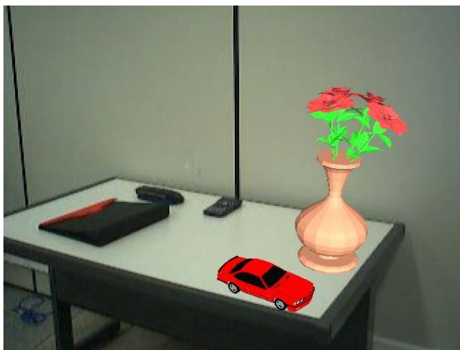
FIGURA 2.6. OBJETOS VIRTUAIS, CARRO E VASO, NO AMBIENTE REAL.
