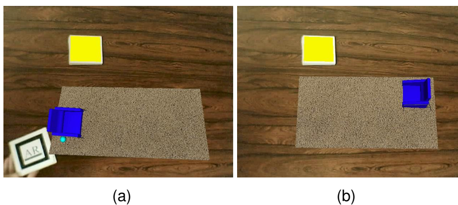
FIGURA 6.19. TRANSPORTE DO OBJETO VIRTUAL: A) APROXIMAÇÃO DA ESFERA DO MARCADOR DE TRANSPORTE DO OBJETO A SER COPIADO E B) OBJETO REPOSICIONADO E REORIENTADO ATRAVÉS DO MARCADOR DE TRANSPORTE.
