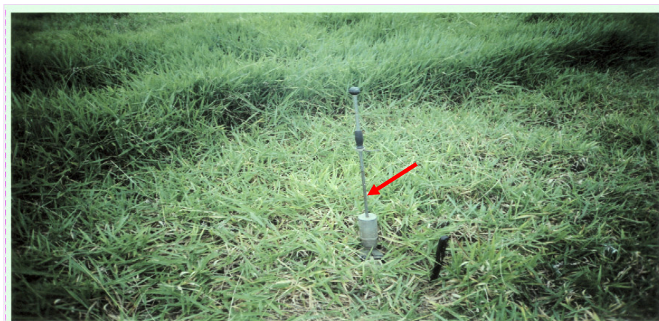
Figura 5 – Determinação da resistência mecânica do solo à penetração
