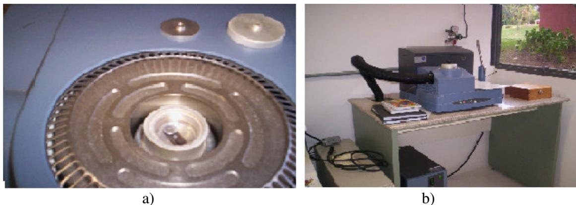
Figura 4.10 a) detalhe do porta amostras do equipamento de DSC e b) o equipamento de DSC TA Q10 utilizado para a realização das medidas de calorimetria.
