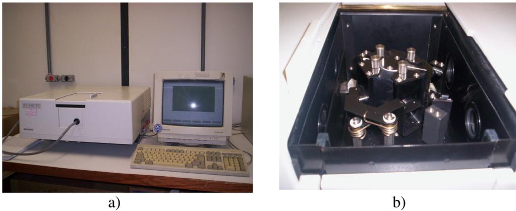
Figura 4.7 a) Foto do espectrofotômetro UV 240 utilizado e b) porta amostras com o fotomultiplicador acoplado utilizado para as medidas.
