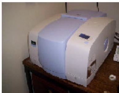
Figura 4.8 – Equipamento Perkin Elmer modelo Spectrum 100 utilizado no experimento para as medidas de FTIR.
