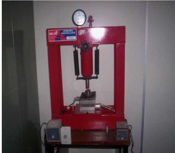
Figura 4.1 - A foto mostra as chapas aquecedoras acopladas à prensa, para preparação de filmes a partir da fusão.
