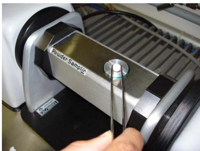
**Figura 9:** Suporte para centralizar a amostra sob a fonte de radiação.
