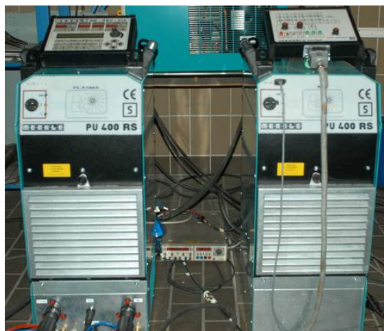
Figura 4.1 – Fontes de soldagem da bancada n. 1.
