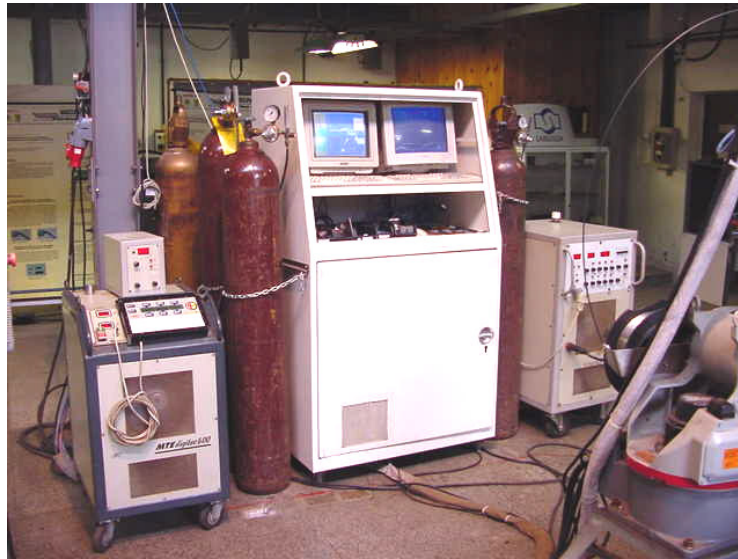
Figura 5.7 - Central de controle e aquisição e fontes de soldagem
