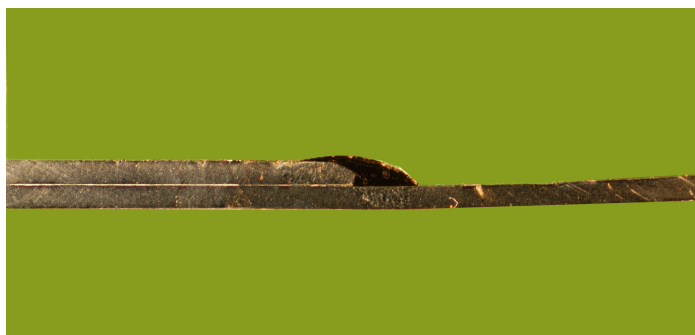
Figura 7.7 – Seção transversal de brasagem realizada pelo processo Plasma-MIG. V_s = 3 m/min. Parâmetros: Tabela 8.5.
