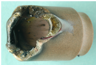
Figura 6.6 - Bocal de isolamento cerâmico danificado pelo arco plasma
