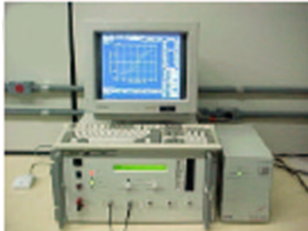
Figura 3.8: Equipamento “Radiant Technology RT 6000 HVS” para verificar curvas de histerese—caracterização ferroelétrica
