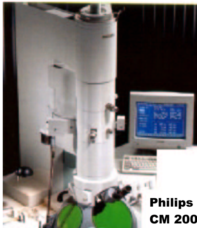
Figura 3.7: Equipamento “Philips CM 200” usado nas análises realizadas por MET
