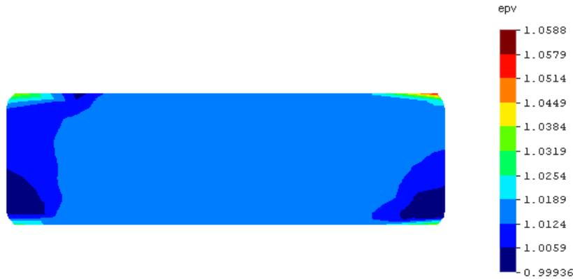
Figura 6.23: Deformação plástica volumétrica  $\epsilon_v^p$ .
