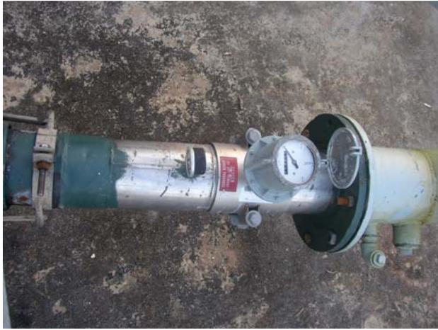
Figura 39. Medidor de vazão instantâneo (l/s) e totalizador (m<sup>3</sup>) acoplado ao pivô central na Fazenda Capim II, Capim/PB, 2005
