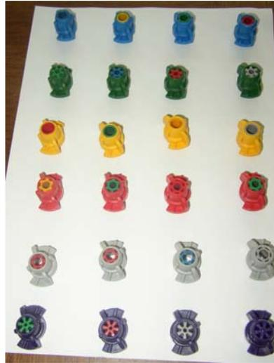
Figura 40. Bocais utilizados no equipamento de irrigação na Fazenda Capim II, Capim/PB, 2005
