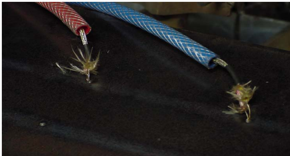
Figura 4.20 - Termopares instalados no verso da chapa
