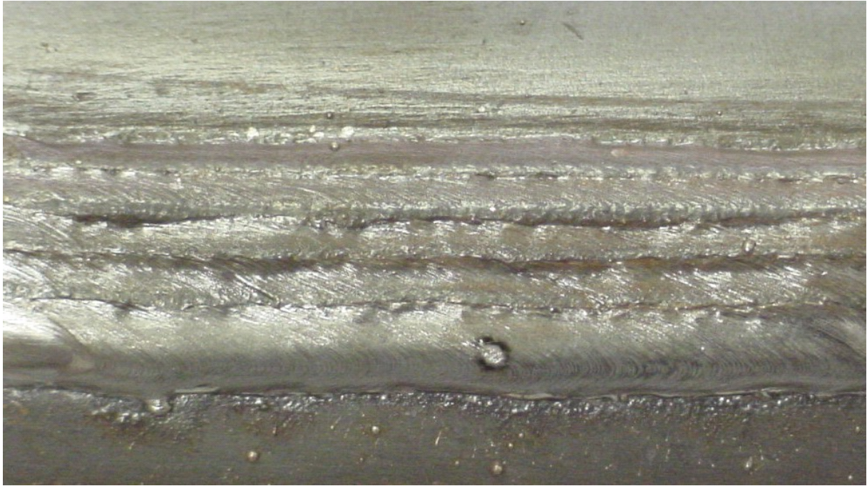
Figura 6.8 - Depósito de revestimento sobre tubo
