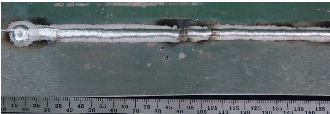
Figura 3.7 - Junta sobreposta MIG CA – Alumínio, chapas de 1 mm de espessura
