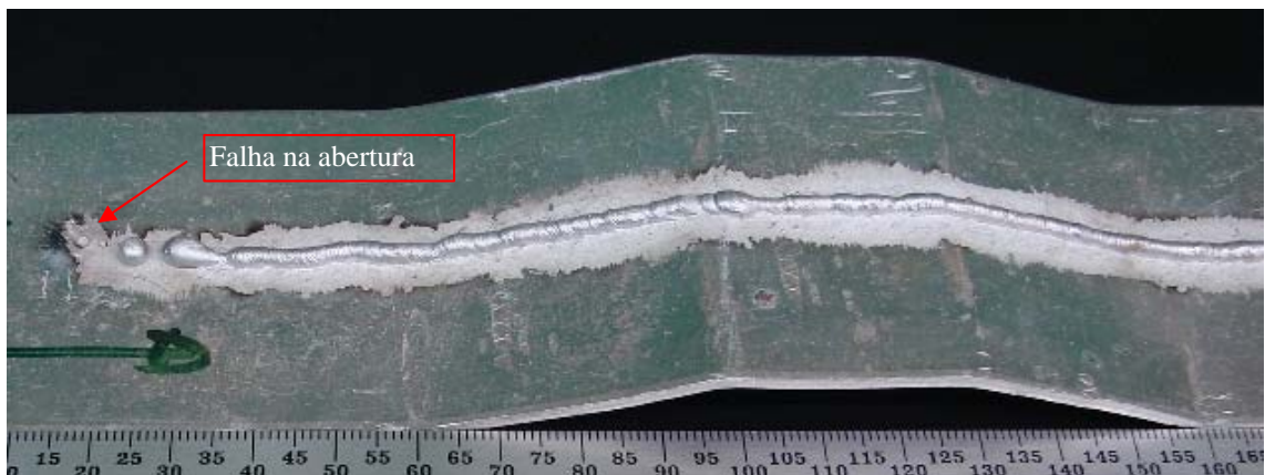
Figura 3.9 - Depósito obtido com variação progressiva da distância bico peça
