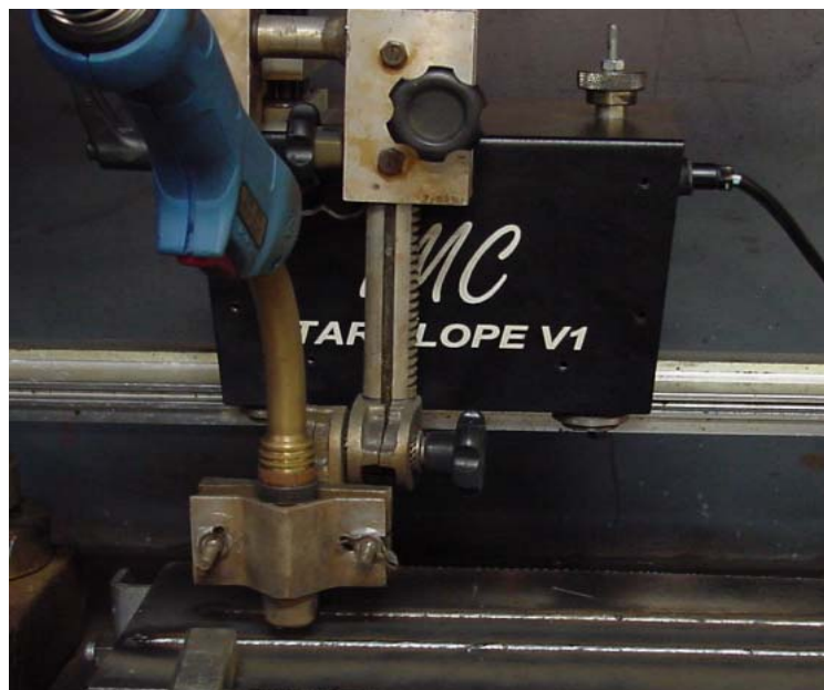
Figura 4.17 - Sistema de deslocamento de tocha (Tartílope)
