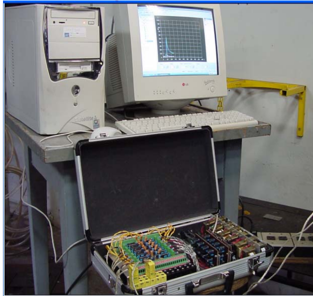
Figura 4.21 - Sistema de monitoração de temperatura
