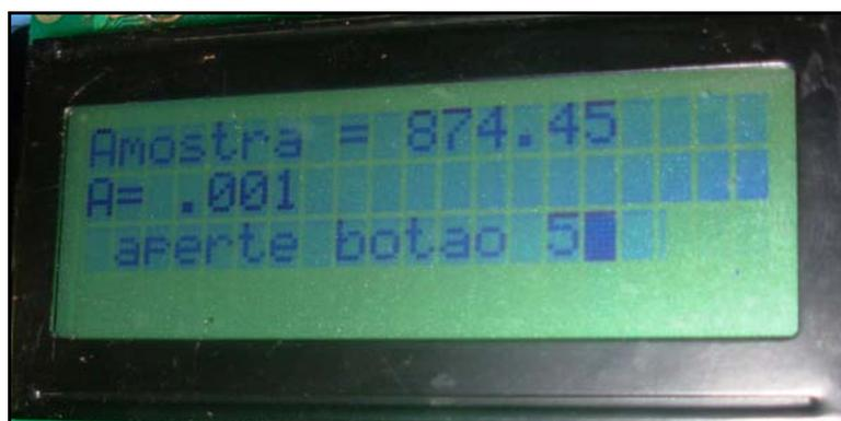
Figura 2.19. Tela do instrumento proposto apresentando o resultado da análise de uma amostra em absorbância.
