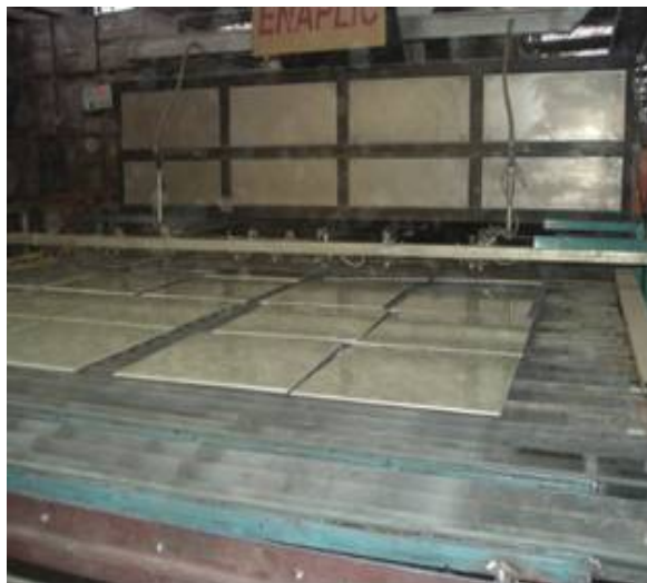
Figura 3.6 - Saída dos revestimentos cerâmicos do interior do forno.
