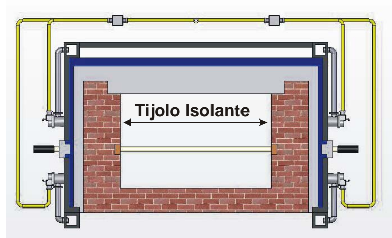
Figura 3.1 – Vista frontal de um forno a rolos mostrando a posição dos tijolos isolantes colocados na parte interna do forno.
