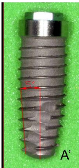
Figura 8. Imagem do implante cônico (A') mostrando uma cônica de 5°.
