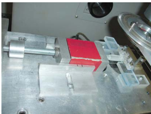
Figura 6.24 a) – Dispositivo de carga + célula de carga e modelos (no polariscópio vertical).
