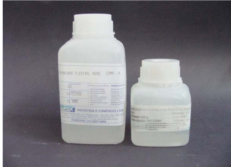
Figura 6.2 – Recipientes dos Componentes A e B (Fabricante Polipox), para a produção dos modelos fotoelásticos.
