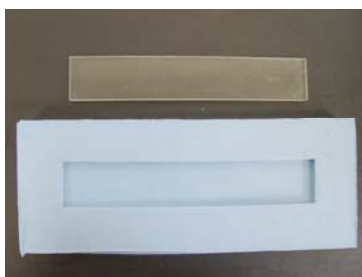
Figura 6.4 a) – Barra prismática e molde em silicone azul.
