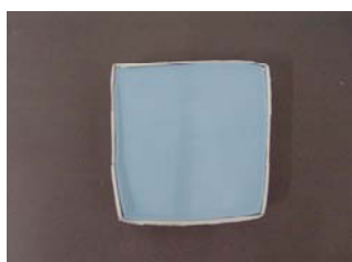
Figura 6.1a – Molde de silicone na forma final.
