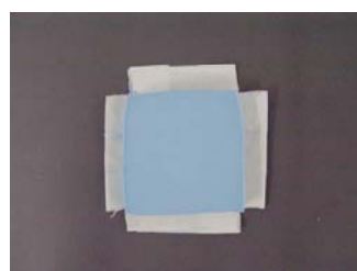
Figura 6.1b – Desmontagem da forma e finalização do molde de silicone.
