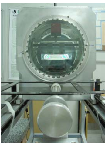
Figura 6.11 a) – Barra de calibração montada no dispositivo de flexão a 4 pontos visualizada no polariscópio portátil do LTM.
