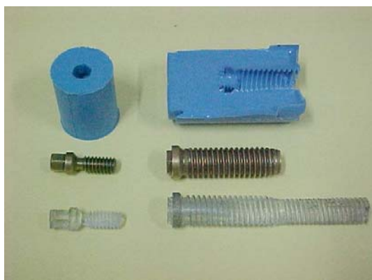
Figura 5.3 – Exemplos de moldes em borracha de silicone azul e modelos fotoelásticos 3D produzidos.
