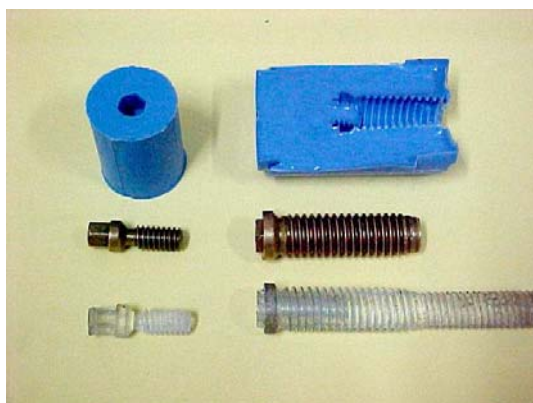
Figura 6.20 – Moldes gerados, peças originais e modelos em resina fotoelástica.
