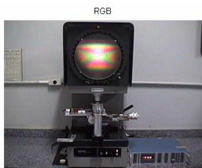
Figura 6.6a – Polariscópio Vertical do LPM com o dispositivo de compressão diametral posicionado
