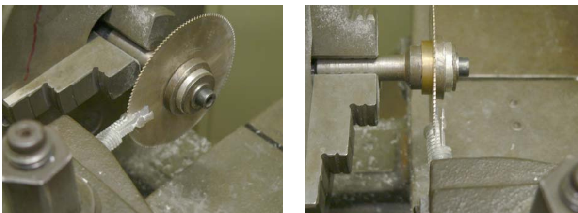
Figura 6.22 – Corte do conjunto montado e geração das fatias das peças em resina fotoelástica.
