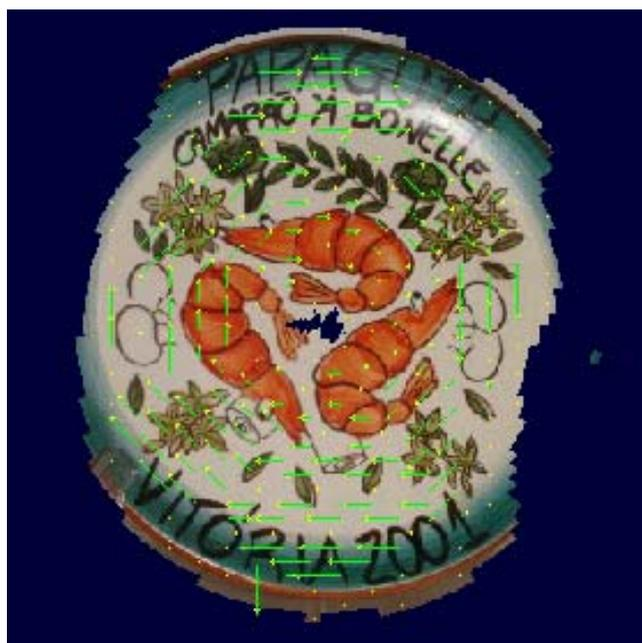
Figura 93 – Representação visual das velocidades resumidas num grid de largura 16 x 16 pixels. Em cada quadrado do grid é representada a velocidade da célula que possui menor valor de saída MT.
