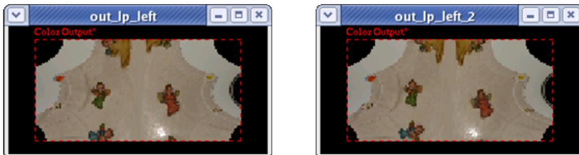
Figura 65 – Mapeamento log-polar das imagens, em torno do centro de atenção (358, 271), nos instantes 1 e 2, após a seqüência de movimentos oculares de sacada.
