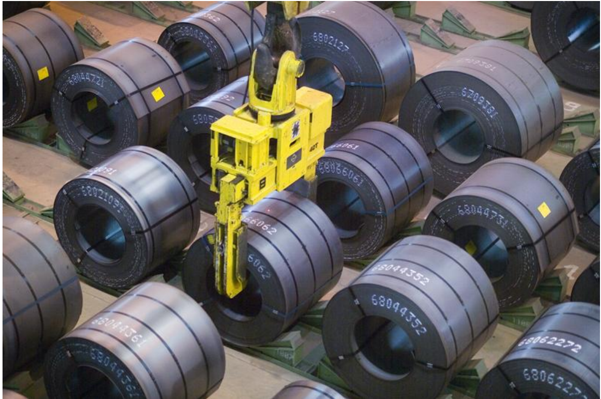
Figura 10: Garra da ponte rolante se preparando para movimentar uma bobina
