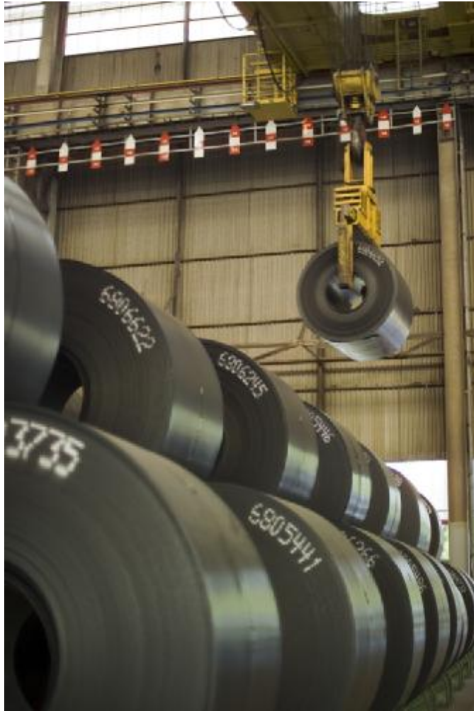
Figura 12: Bobina sendo movimentada pela garra da ponte rolante
