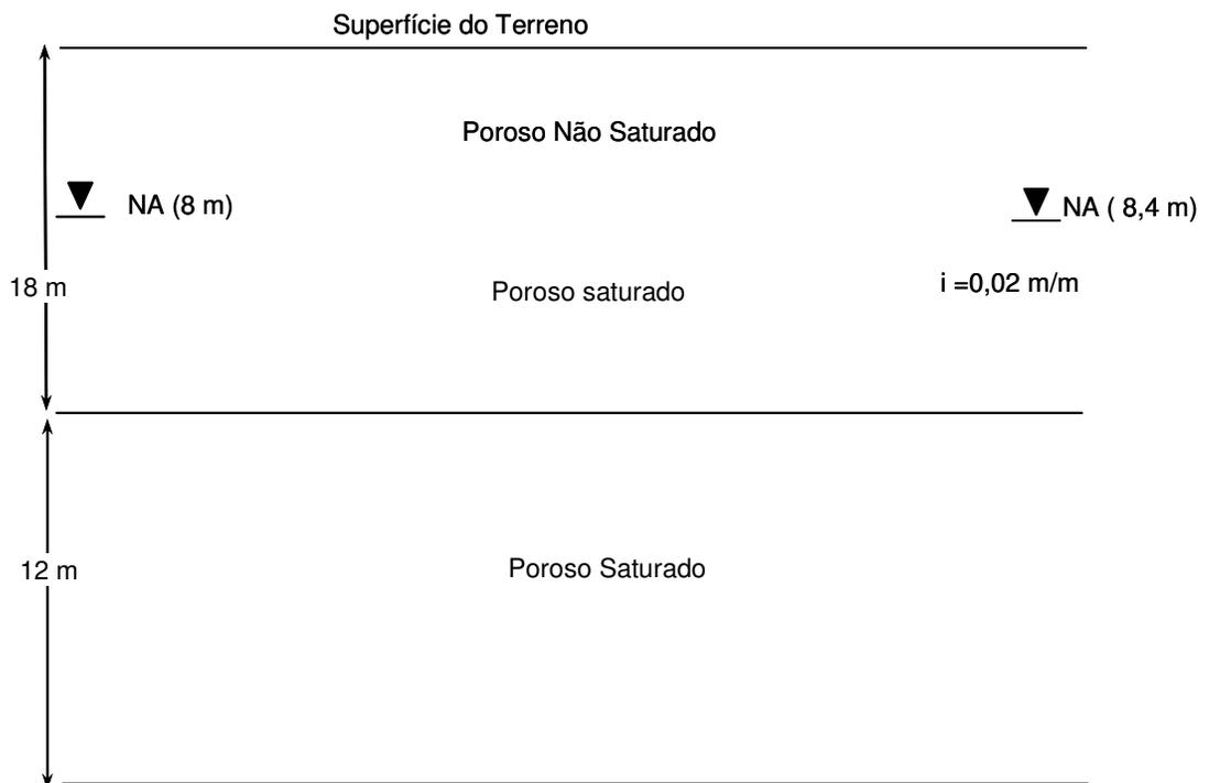
Figura 6.7 Modelo Hidrogeológico da Geometria 1.
