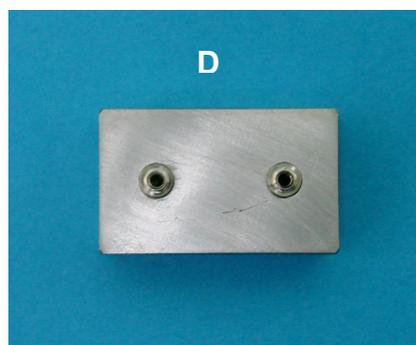
**Figura 1c e 1d - Os dois implantes instalados paralelamente**
