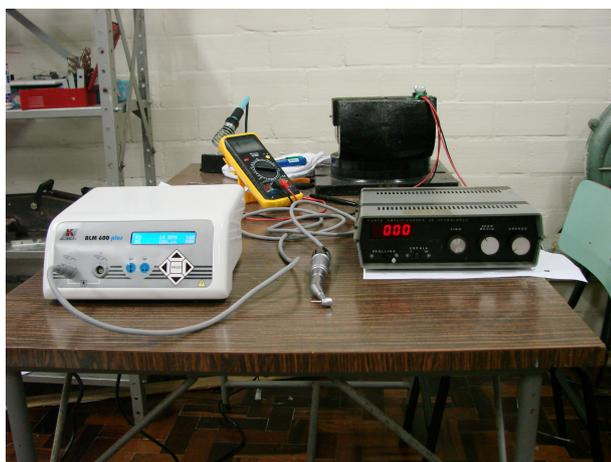
**Figura 9 - Aparelhos utilizados na medição de deformação das infra-estruturas**
