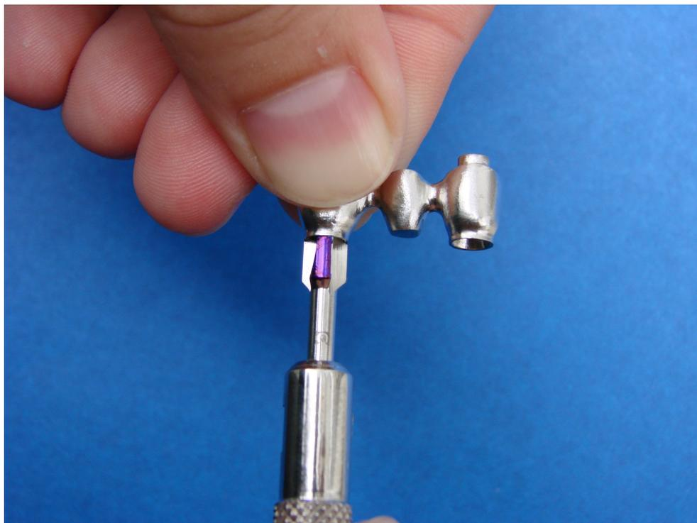
Figura 6 - Retificação manual do cilindro calcinado da infra-estrutura.
