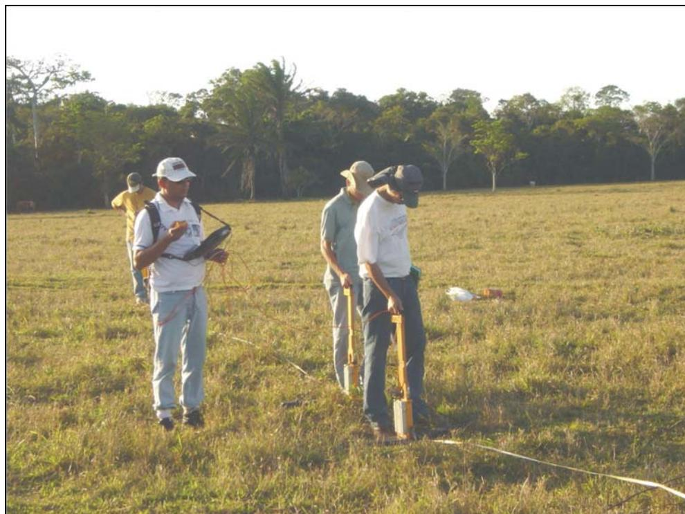
Figura 22. Obtenção dos perfis com GPR (Ground – Penetrating Radar).
