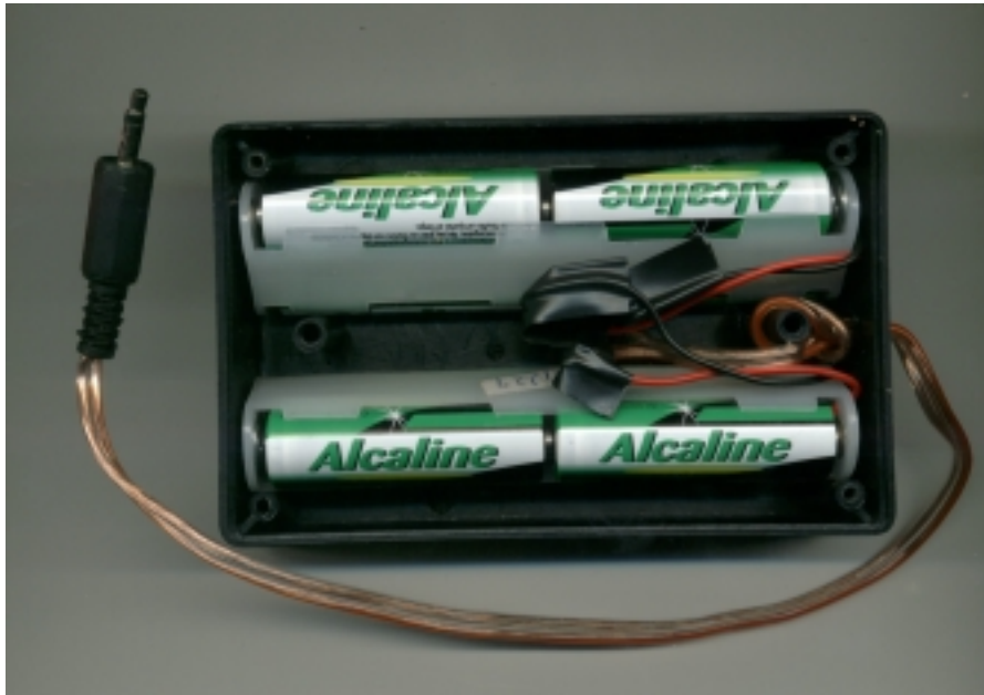
Figura 51 - Fonte adaptadora alternativa de 12V CC
