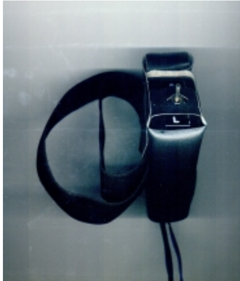
Figura 45 - Fita dupla de fixação do dispositivo de biotelemetria
