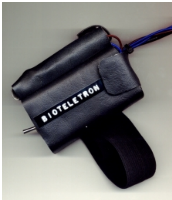
Figura 44 - Capa protetora do circuito de transmissão
