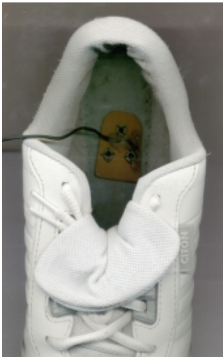
Figura 37 - Sensor dentro do tênis
