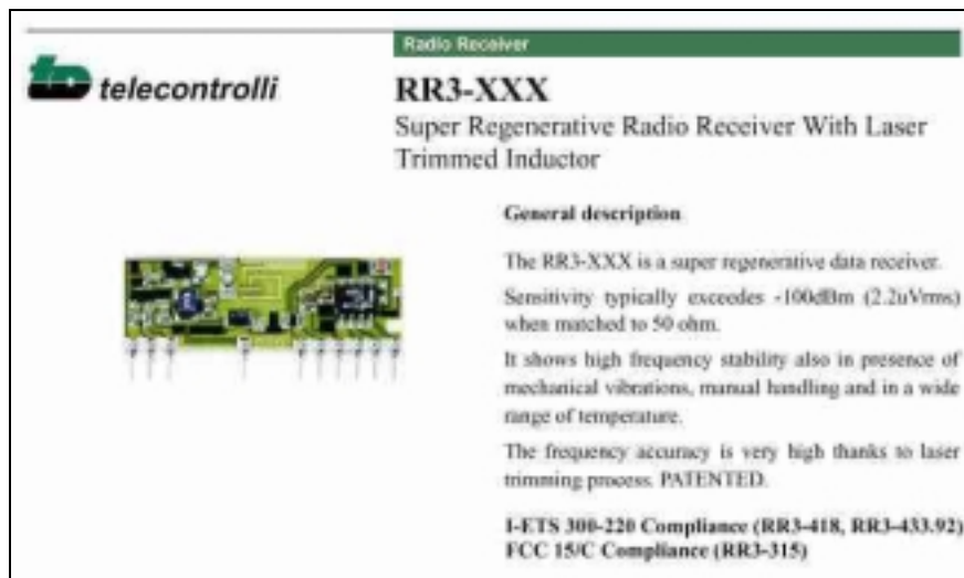
Figura 18 - Módulo receptor de RF RR3-XXX
