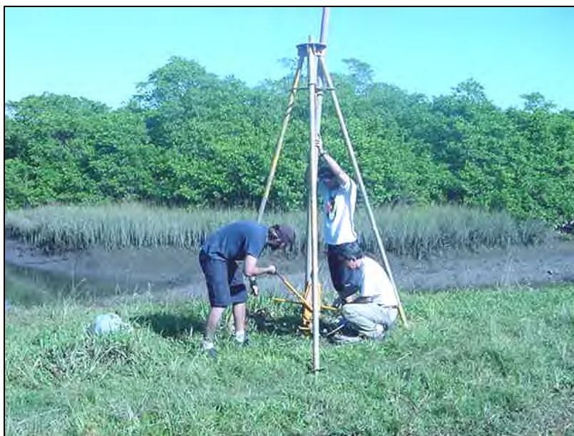
Figura 20 – Coleta de sedimentos em subsuperfície com o auxílio de testemunhador à percussão.
