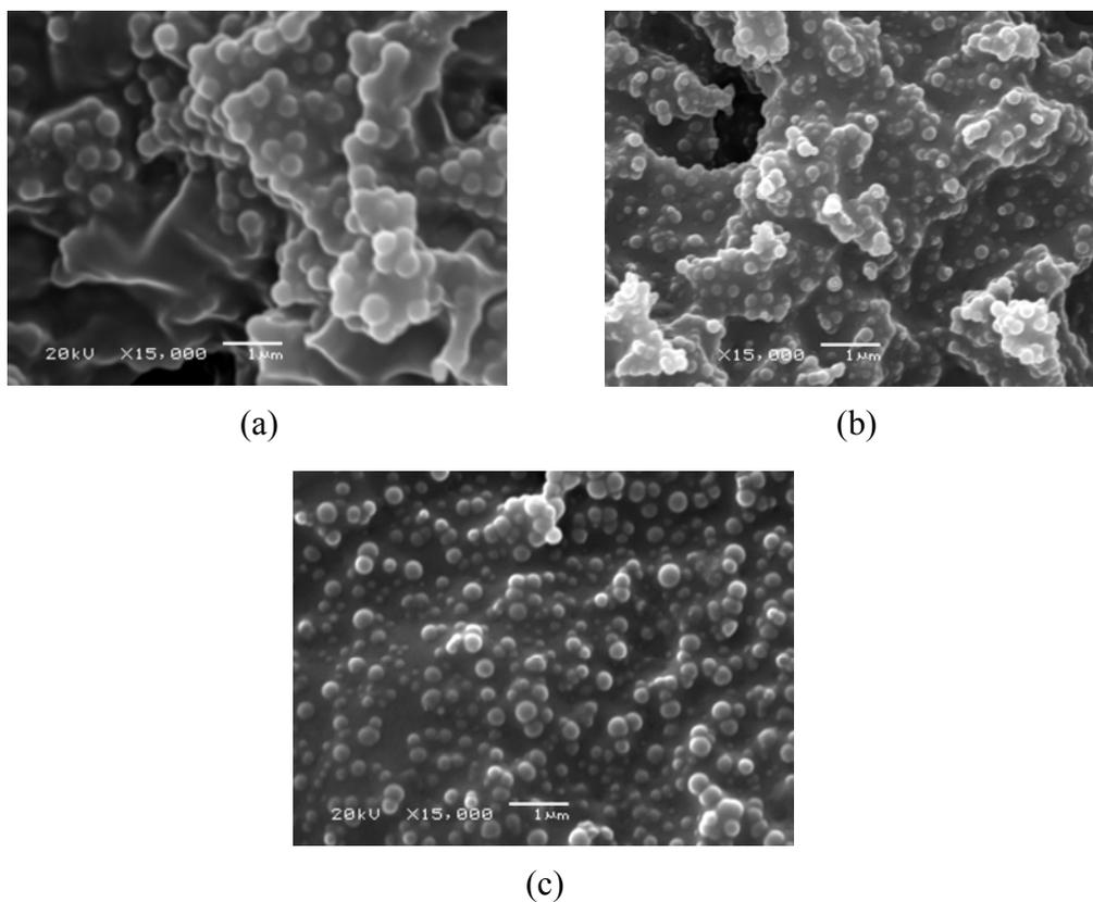
**Figura 42.** Imagens de SEM das sílicas: (a) SG10A, obtida com agitação de 150 rpm; (b) SG10AD1, obtida com o uso do dispersor em 14.000 rpm e (c) SG10AD2, obtida com o uso do dispersor em 24.000 rpm (Magnificação de 15.000 vezes).
