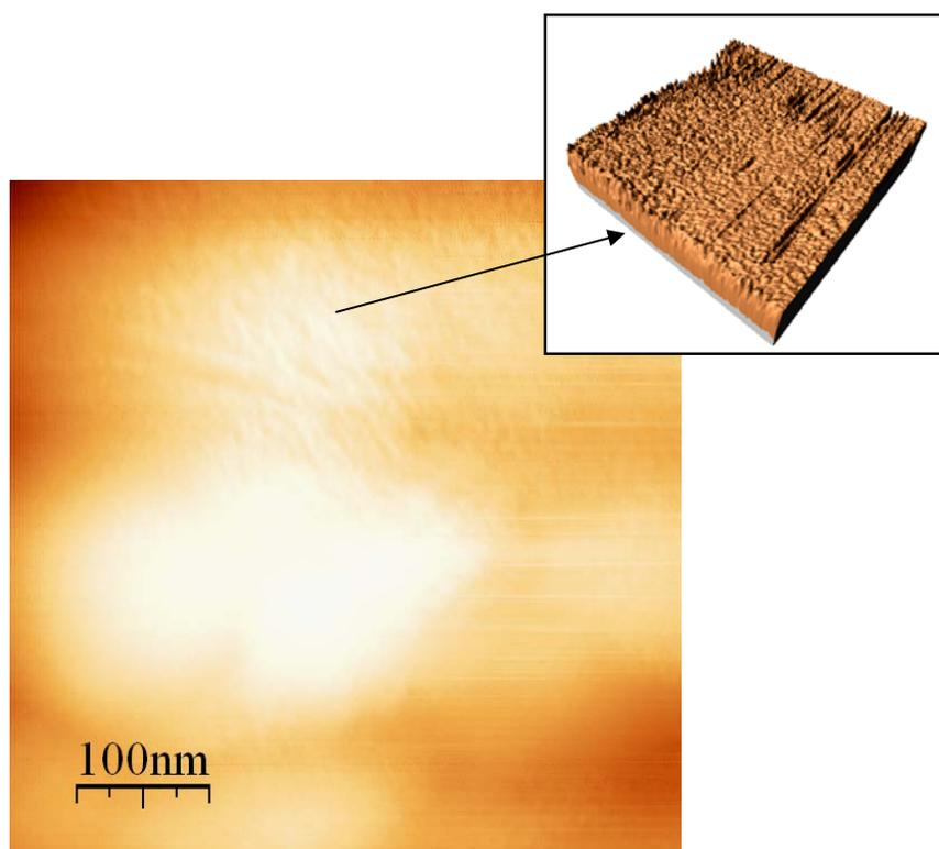
**Figura 35.** Imagem de AFM na escala nanométrica do sistema híbrido sílica- ODS SG10A. No detalhe, imagem tridimensional das cadeias de ODS.
