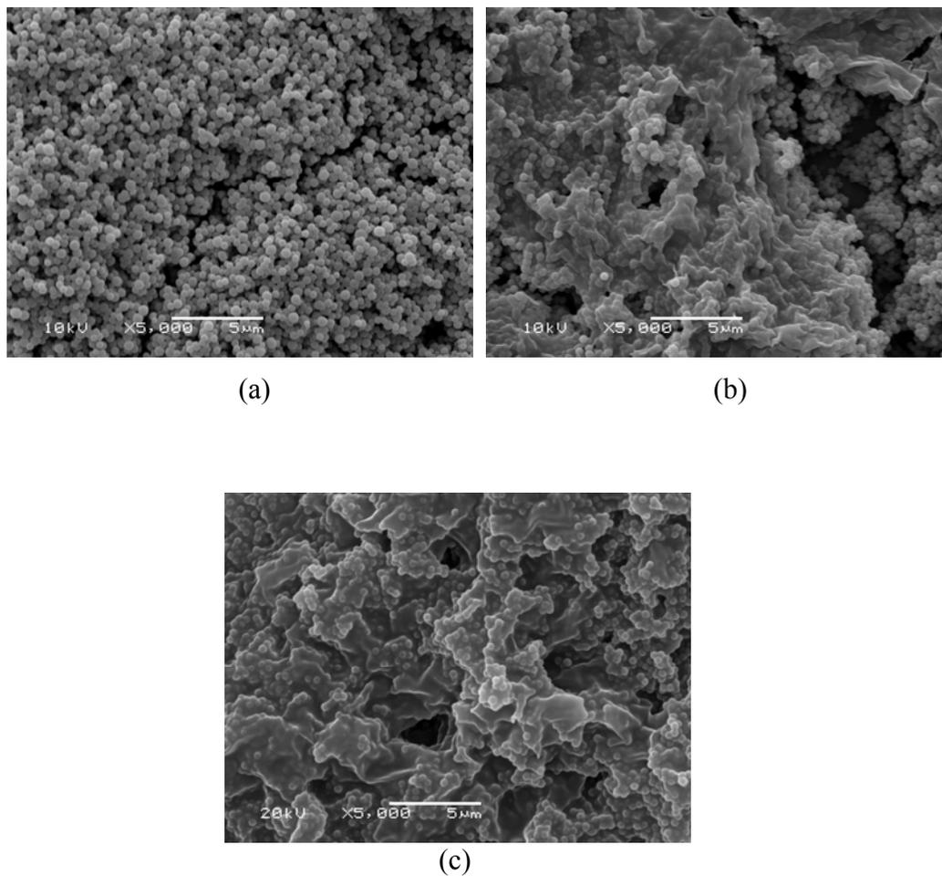
**Figura 39.** Imagens de Microscopia Eletrônica de Varredura das sílicas: (a) SG10C; (b) SG10B e (c) SG10A (Magnificação de 5.000 vezes).
