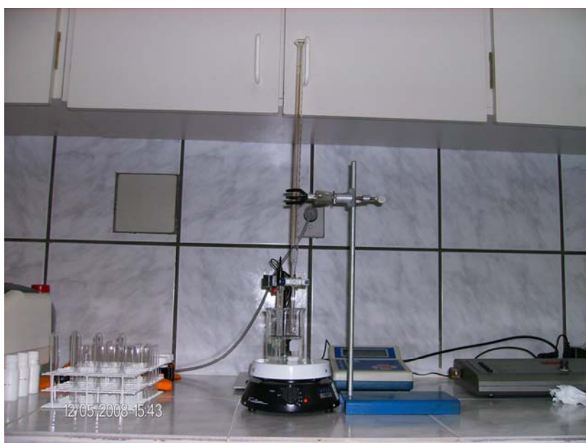
Figura 3.11: Sistema de variação do pH para o HCl e/ou Flocon 100
