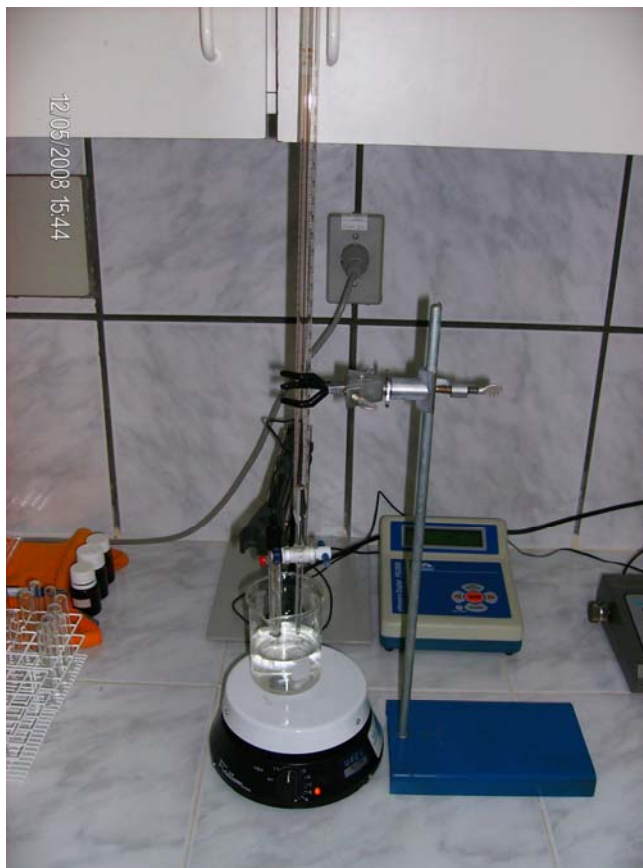
Figura 3.12: Sistema de variação do pH para o HCl e/ou Flocon 100
