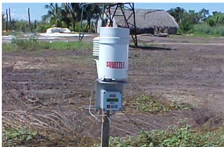
Figura 6. Estação climatológica automática ISIS ® , da empresa “Sqüintter do Brasil”, utilizada na tomada de dados de pluviosidade e temperatura máxima, mínima e umidade relativa do ar. Barreiras, BA, 2004.
