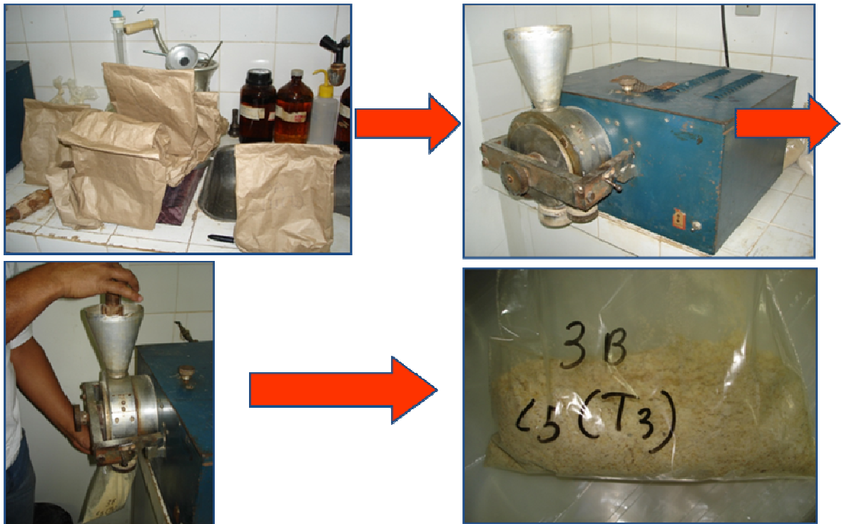
Esquema 1 – Extração do óleo de soja pelo método de extrusão (MAPA, 2005).
