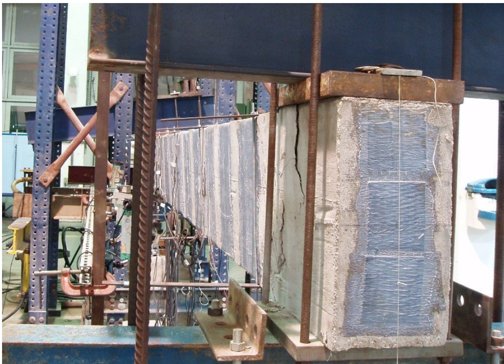
Figura B.21 – Detalhe da viga VT2 solicitada à torção.
