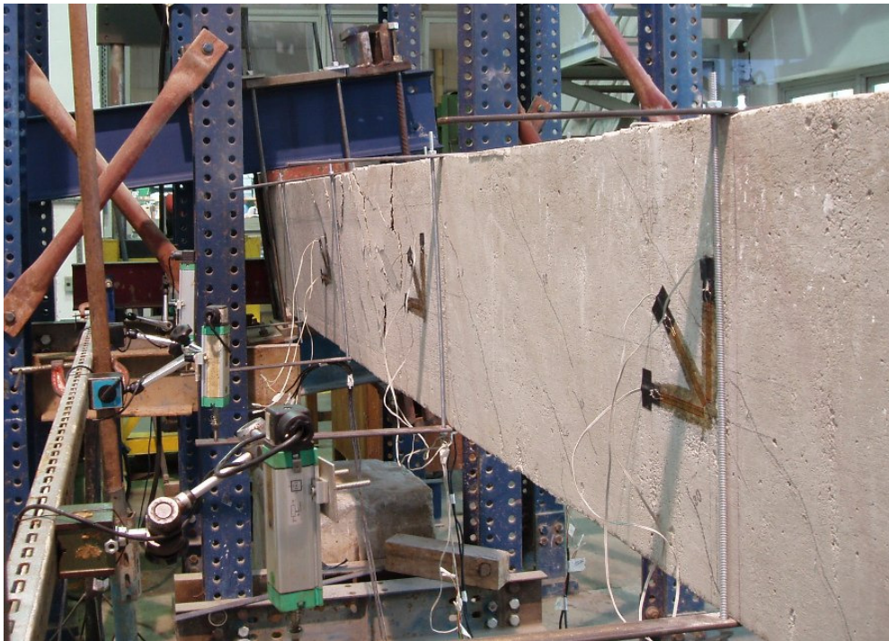
Figura B.9 – Detalhe da torção aplicada na viga VRef.
