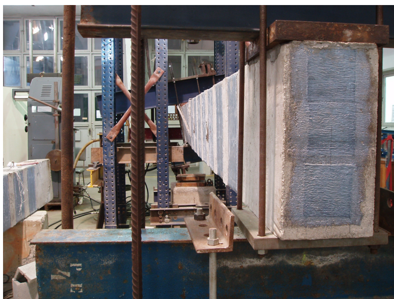
Figura 7.39– Detalhe da torção da viga VT1.
