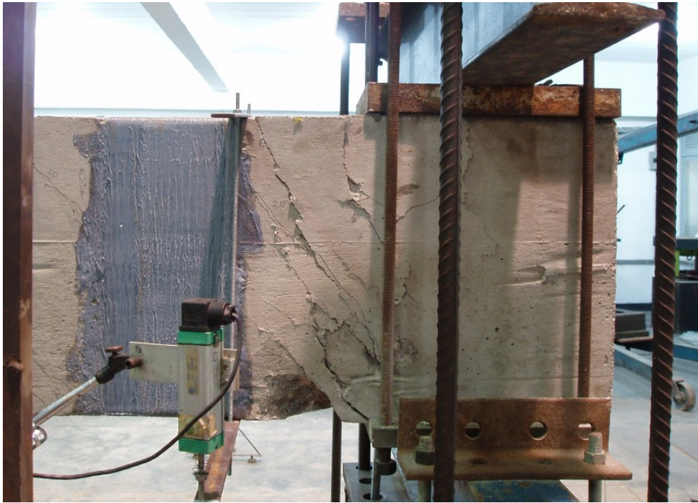
Figura B.22 – Detalhe da ruptura da viga VT2 vista da direita.
