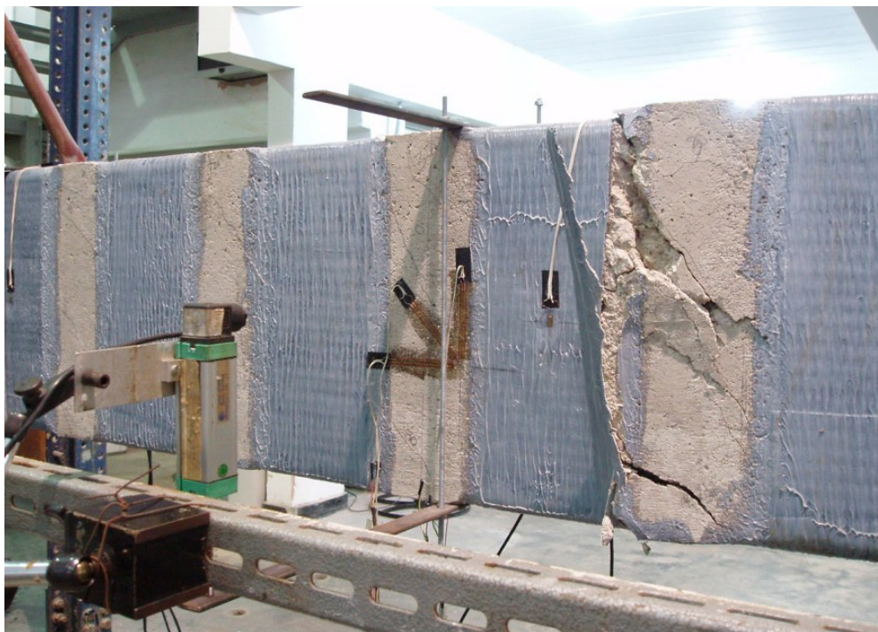
Figura B.14 – Detalhe da ruptura da viga VT1 vista da direita.
