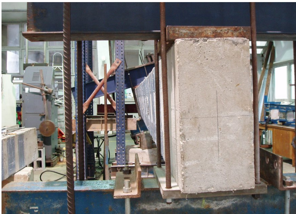
Figura B.48 – Detalhe da viga VTL3 solicitada à torção.
