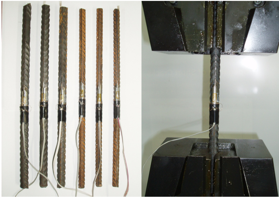
Figura 7.5 – Ensaio das barras de aço.
