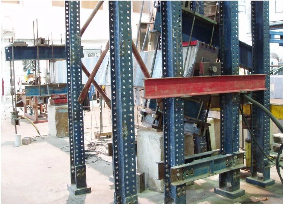
Figura B.25 – Viga VT3 solicitada à torção.
