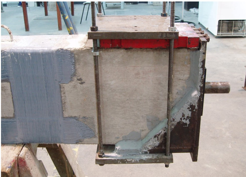
Figura B.3 – Montagem do sistema de apoios: a) marcas para posicionamento das peças; b) montagem do sistema de apoio; c) aplicação de massa plástica para fixação das peças.
