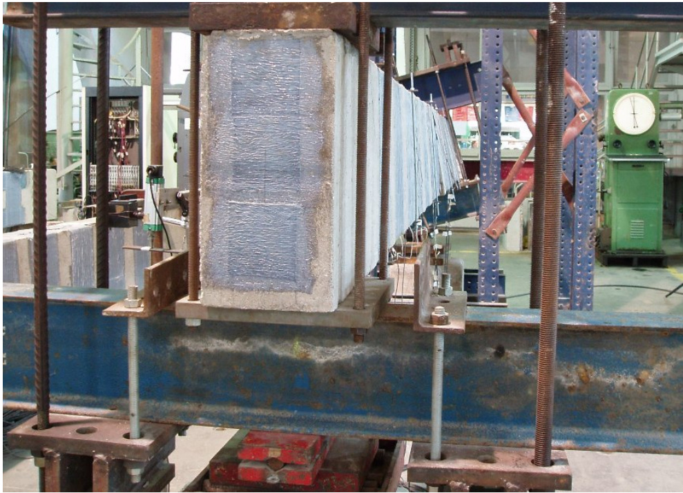
Figura B.27 – Detalhe da viga VT3 solicitada à torção.
