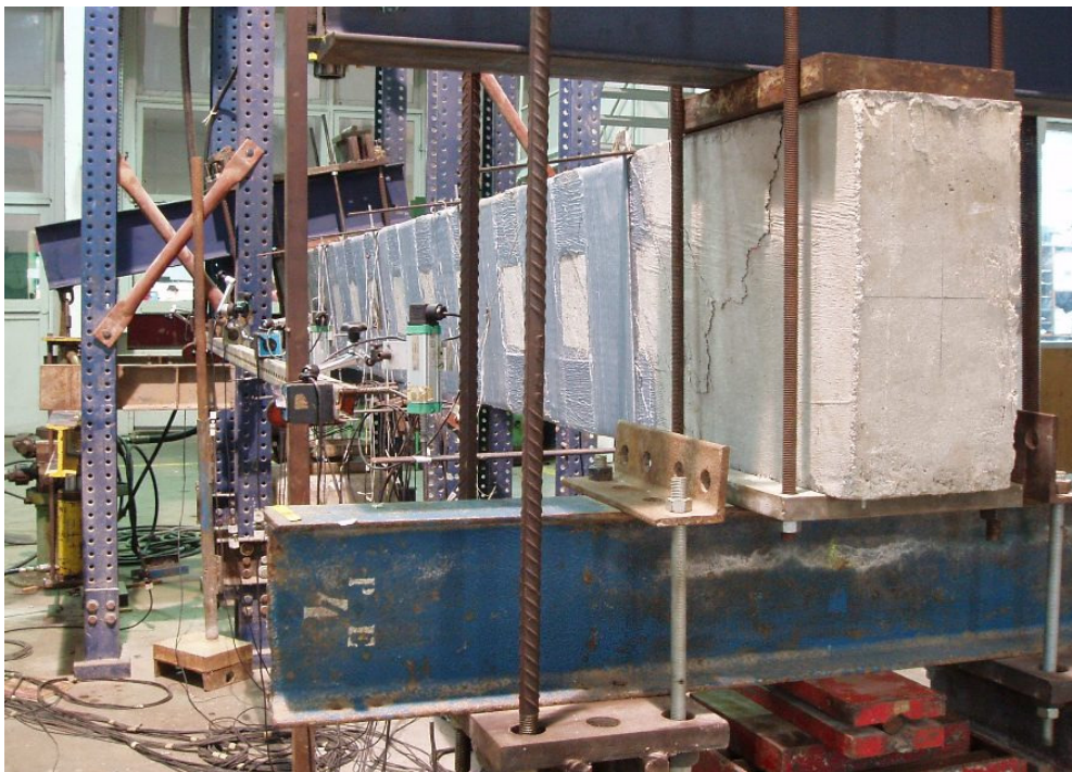
Figura B.40 – Detalhe da viga VTL2 solicitada à torção.
