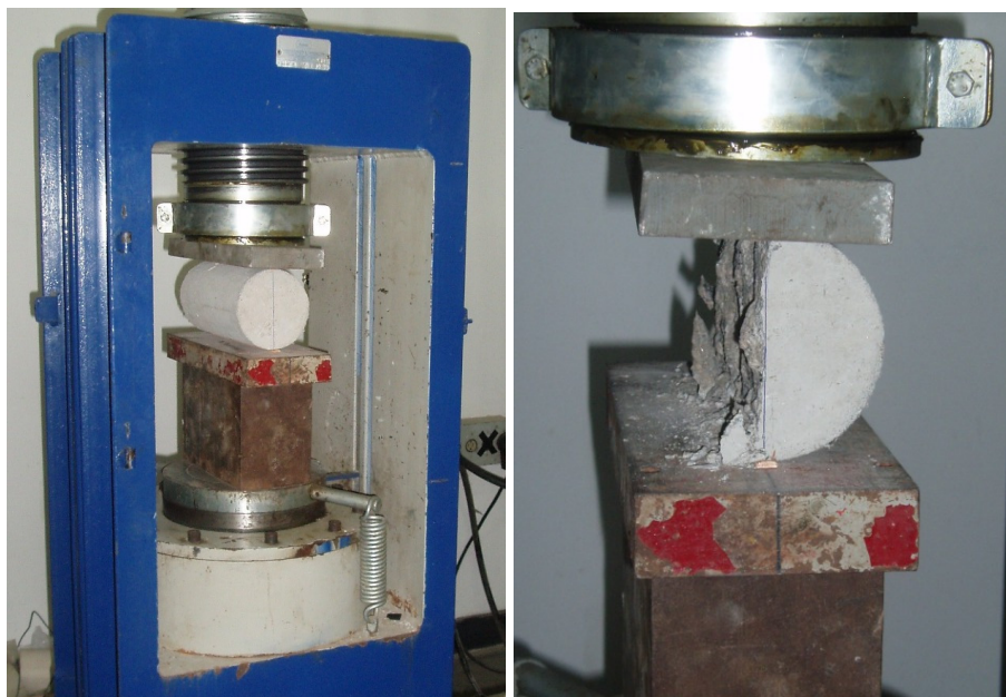
Figura 7.9 – Ensaio de determinação da resistência à tração do concreto por compressão diametral.
