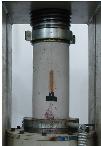
Figura 7.10 – Ensaio de módulo de elasticidade do concreto.
