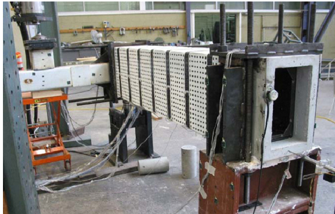
Figura 5.12 – Configuração inicial da viga (Hii e Al-Mahaidi, 2006).
