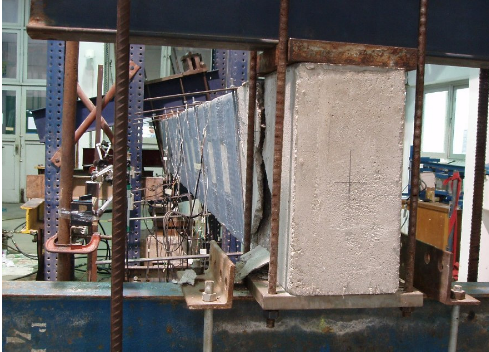
Figura B.34 – Detalhe da viga VTL1 solicitada à torção.
