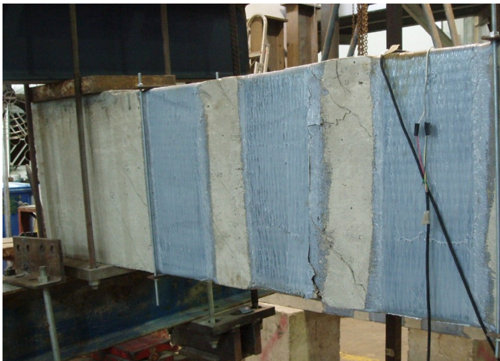
Figura B.15 – Detalhe da ruptura da viga VT1 vista da esquerda.
