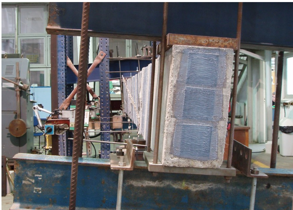
Figura B.13 – Detalhe da torção aplicada na viga VT1.
