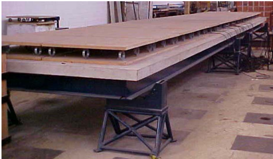
Figura VII.1 – Vista geral da passarela, podendo-se observar as vigas, o tabuleiro, os apoios e as células de carga (FAÍSCA, 2003).
