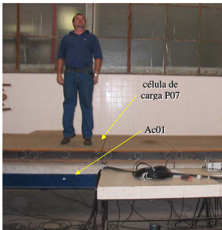
Figura VII.7 – Ensaio de heeldrop a \frac{1}{4} de vão.
