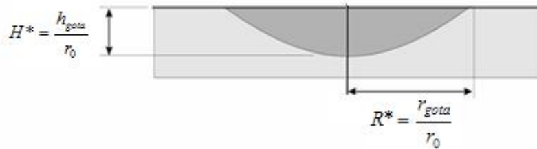
Figura 18 -. Definição do Fator de espalhamento ( R^* ) e da profundidade de penetração ( H^* ) Reis (2000).
