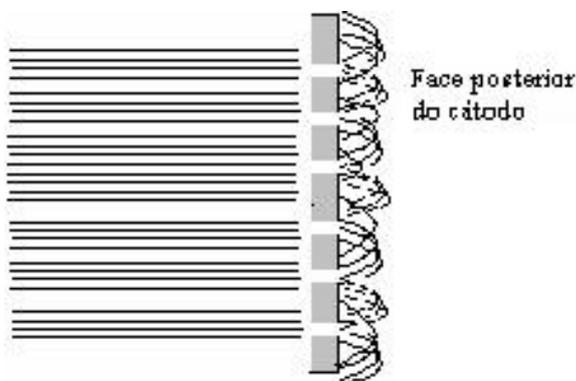
Figura 4: Provável distribuição de corrente no eletrodo perfurado.
