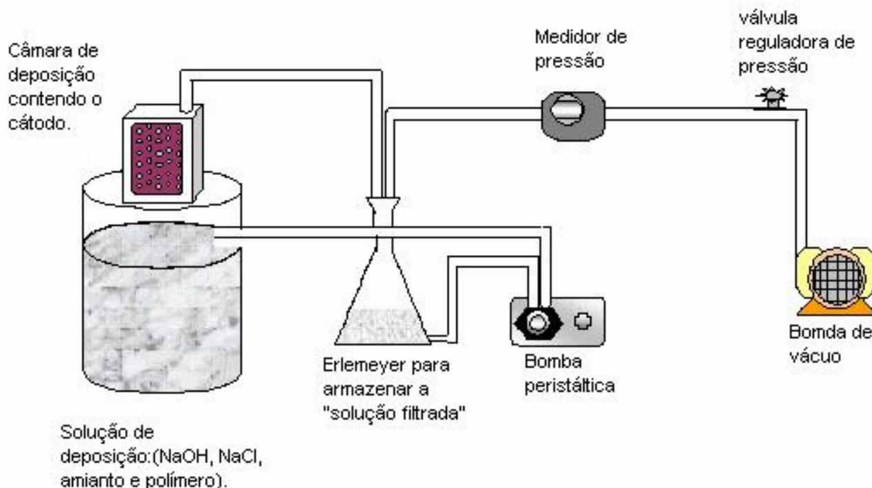
Figura 12: Montagem experimental para deposição dos diafragmas de amianto+SM2.
