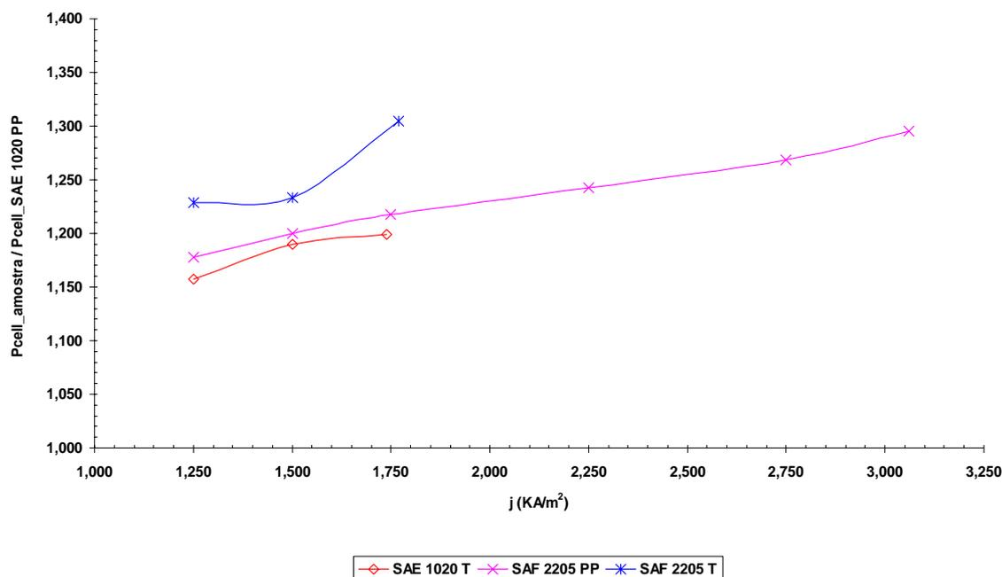
Figura 26: Relação entre a  $P_{cell}$  das amostras e a  $P_{cell}$  da referência (SAE 1020 PP) versus densidade de corrente, com 12% de NaOH ( $T = 50 \pm 3$  °C).
