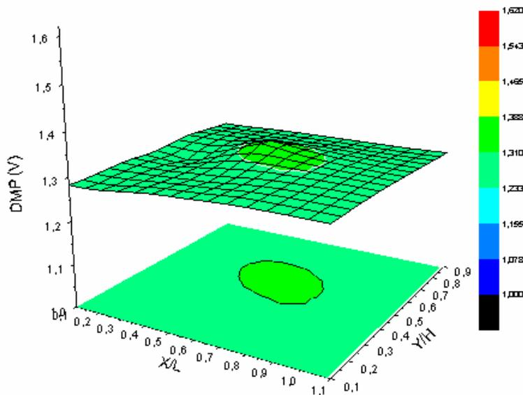
Figura 37: Gráfico de superfície da janela catódica para a amostra SAF 2205 PP nas condições de  $I = 13,1 \text{ A}$  /  $P_{\text{cell}} = 4,50 \text{ V}$  /  $\text{NaOH} = 12,0\%$ .
