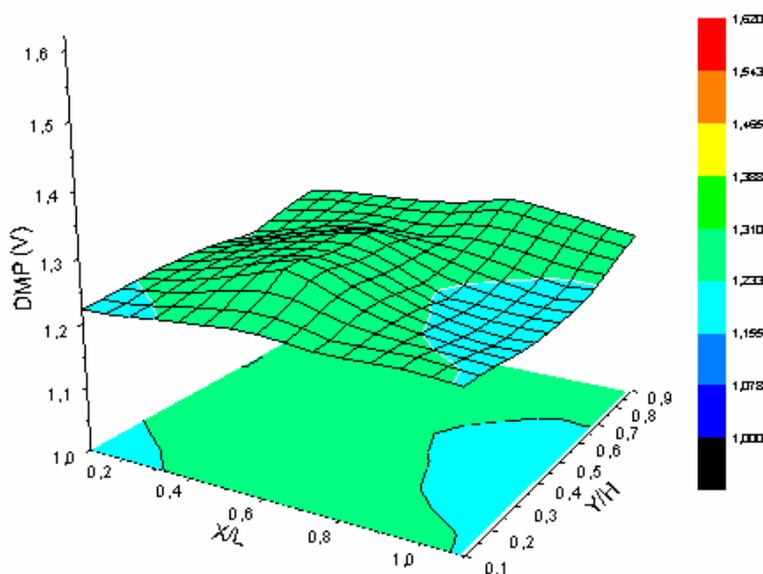
Figura 38: Gráfico de superfície da janela catódica para a amostra SAF 2205 T nas condições de  $I = 13,1 \text{ A}$  /  $P_{\text{cell}} = 4,07 \text{ V}$  /  $\text{NaOH} = 12,36 \%$ .
