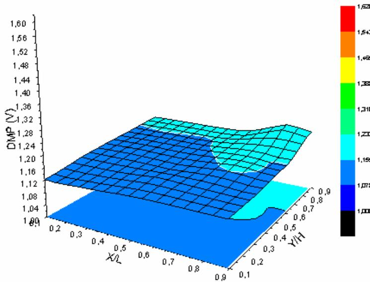
Figura 36: Gráfico de superfície da janela catódica para a referência SAE 1020 T nas condições de  $I = 13,1 \text{ A}$  /  $P_{\text{cell}} = 3,74 \text{ V}$  /  $\text{NaOH} = 12\%$ .
