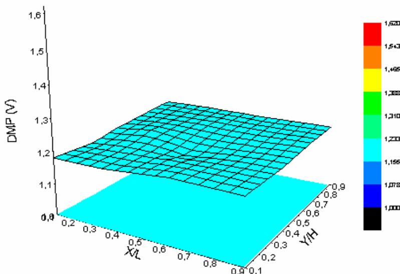
Figura 35: Gráfico de superfície da janela catódica para a referência SAE 1020 PP nas condições de I = 13,1 A / P<sub>cell</sub> = 3,55 V / NaOH = 12%.
