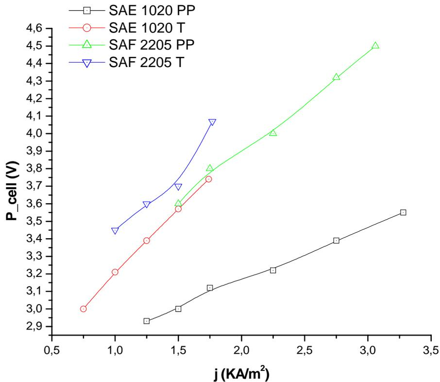
Figura 22: Comparação entre todos os materiais para a  $P_{cell}$  em relação à densidade de corrente com 12% de NaOH ( $T=50\pm 3$  °C).
