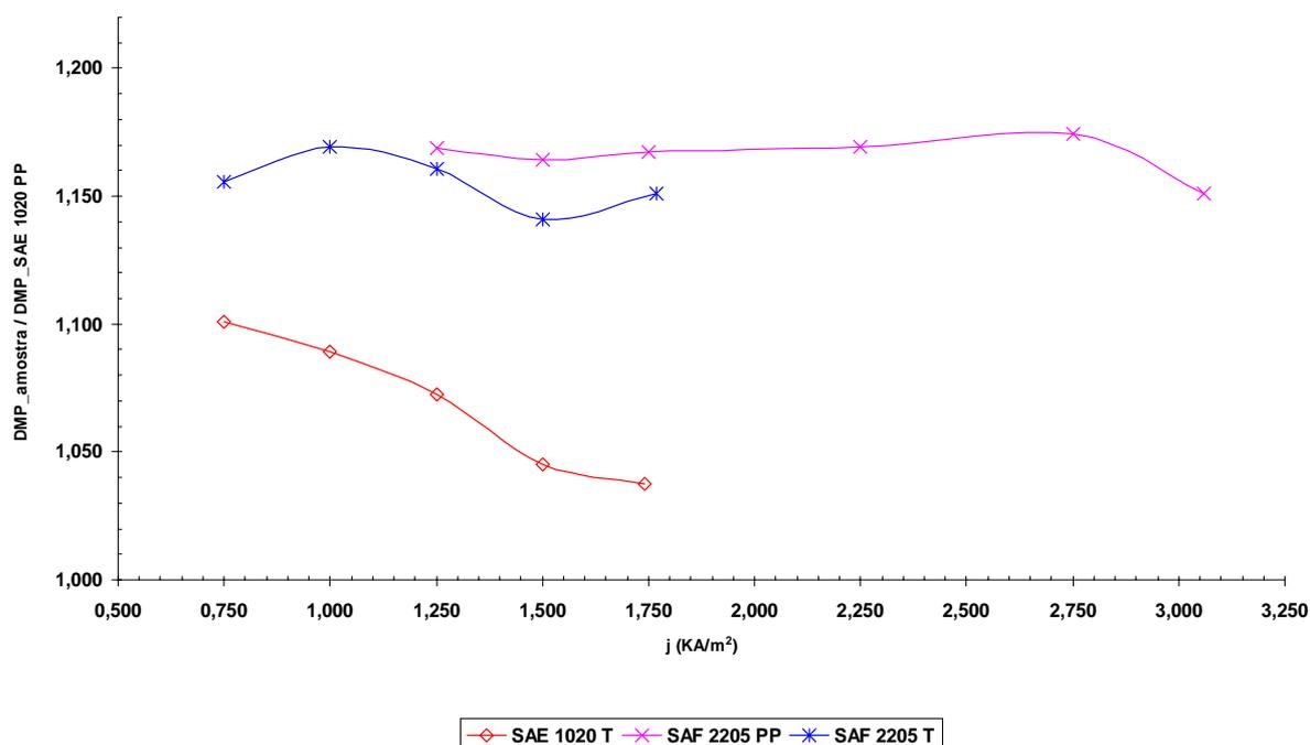
Figura 23: Relação entre a DMP das amostras e a DMP da referência (SAE 1020 PP) durante a polarização ( $T = 30 \pm 3$  °C).
