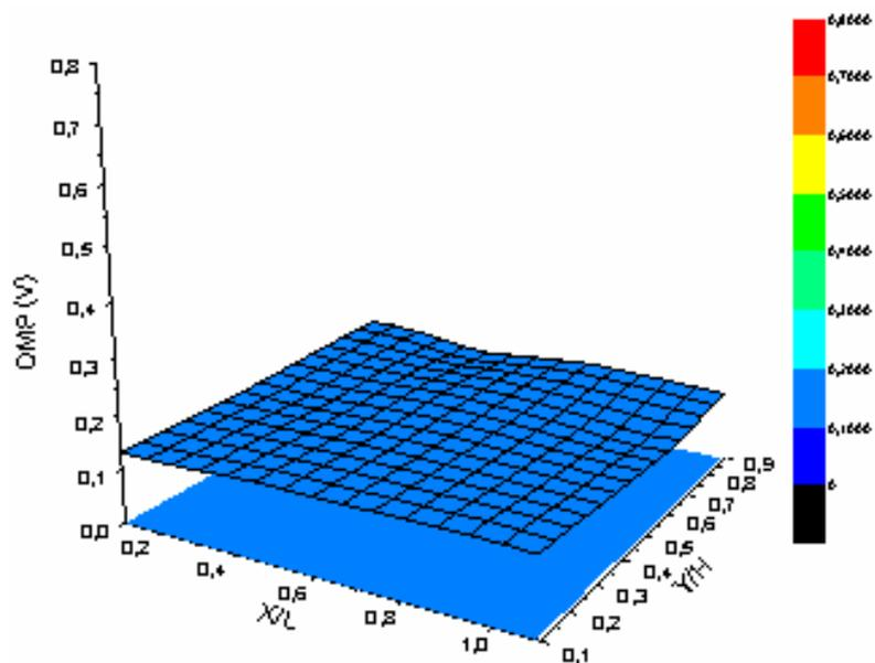
Figura 33:Gráfico de superfície da janela catódica para a amostra SAF 2205 T nas condições de  $I = 0,0 \text{ A} / P_{\text{cell}} = 1,20 \text{ V}$ .
