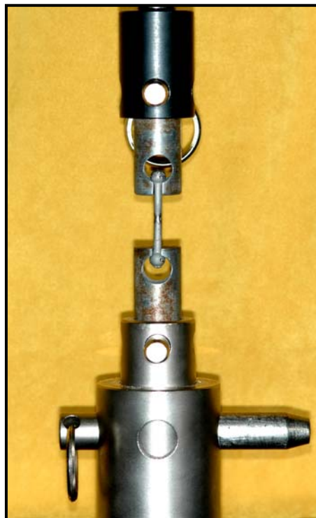
Figura 11 – Corpo de prova posicionado para o teste de resistência à tração
