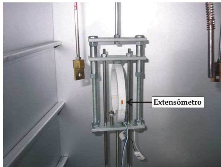
Figura 5.42: Ensaio de um anel em material viscoelástico (PVC) para determinação do módulo de fluência do material.
