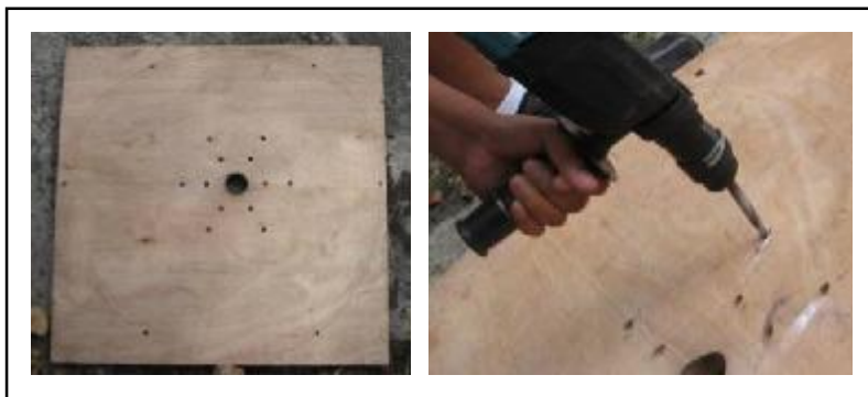
Figura 6.5 – Gabarito de madeira usado para a localização dos pinos e direção dos furos.
