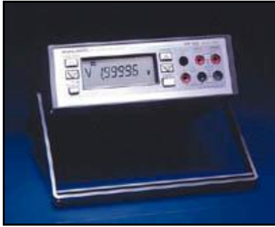
Figura 5.17 – Multímetro digital para registro das variações de voltagem.
