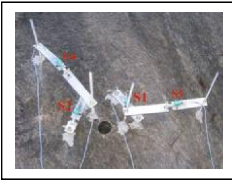
Figura 7.24 – Disposição dos LVDT's no furo IPP-3.
