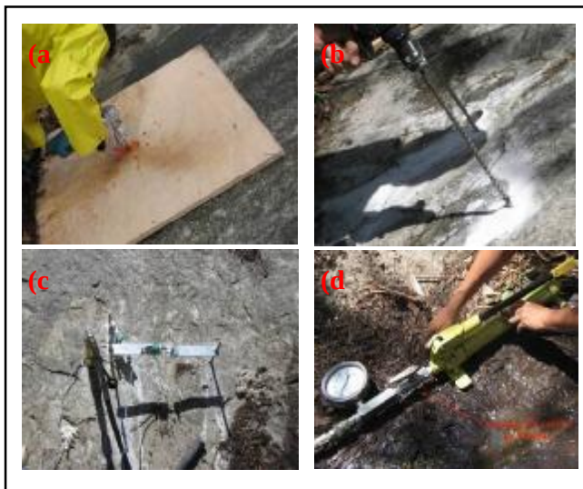
Figura 7.9 – (a) Direcionando o furo central, (b) momento da perfuração dos pinos com o martelo, (c) LVDT's montados para o início da pressurização, (d) macaco hidráulico (detalhe da válvula instalada para controlar o fluxo de óleo).
