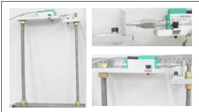
Figura 6.4 – Sistema de suporte para os sensores de deslocamento (LVDTs).
