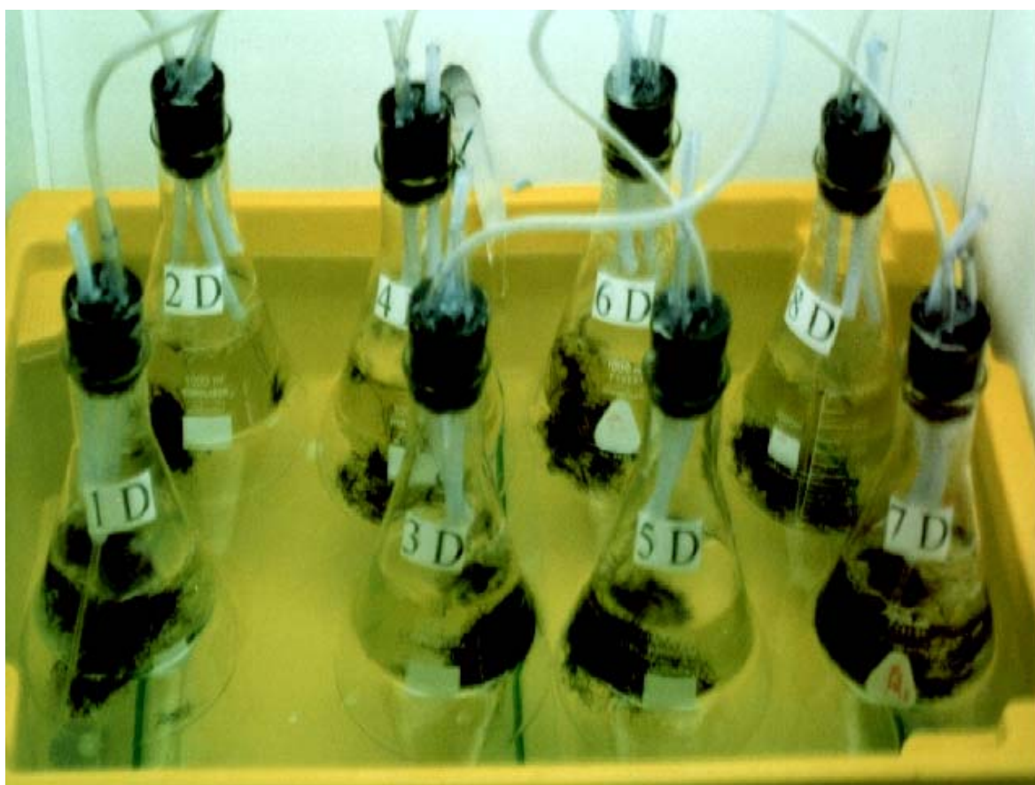
Figura 4 – Manutenção dos frascos de cultivo em imersão à temperatura constante.
