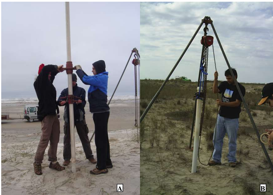
Figura 2: Método de testemunhagem a percussão manual, tendo como testemunhador um tubo de PVC de 6m de comprimento. A) Fase de penetração no solo através de um peso batente. B) Fase de retirada do testemunho utilizando-se tripé e talha.
