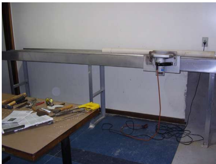
Figura 3: Mesa de abertura de testemunhos, acoplada à serra elétrica circular.
