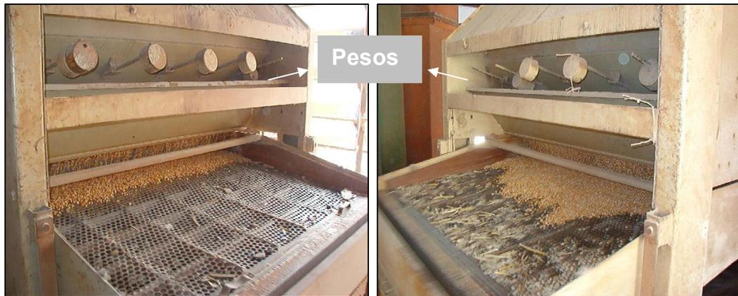
Figura 5 – Disposição dos pesos e distribuição de carga nas máquinas de limpeza.
