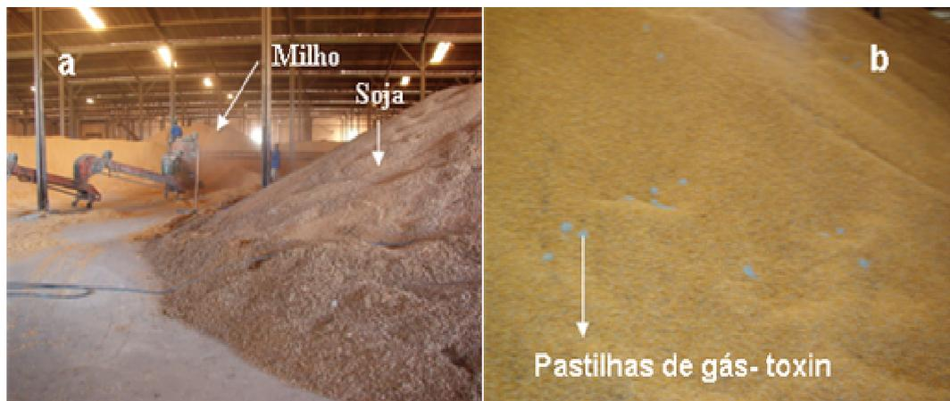
Figura 9 – Armazém do IBC – sistema de movimentação e forma de estocagem (a) tratamento do produto (b).
