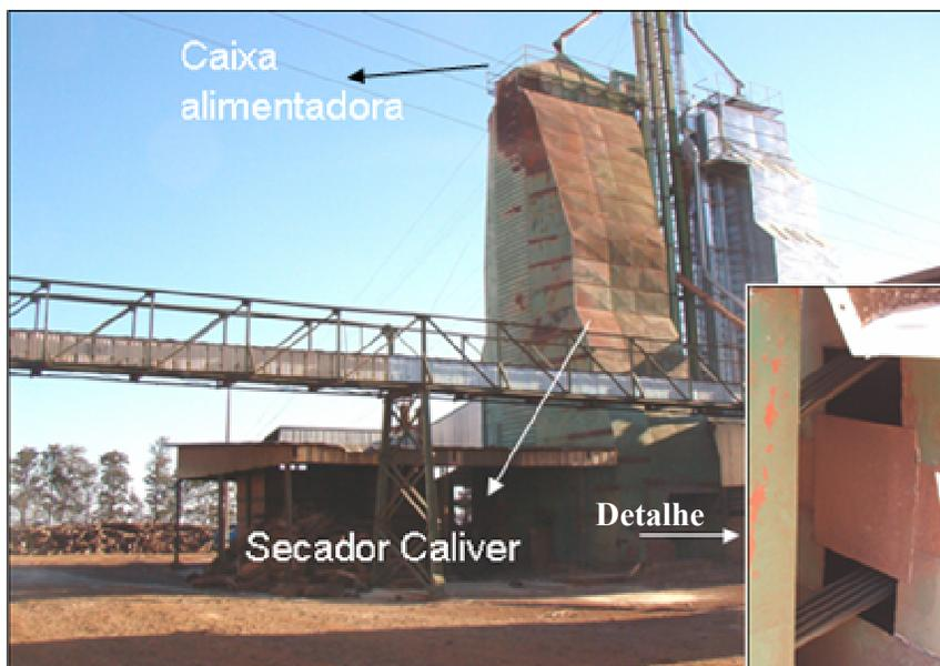
Figura 4 – Secador Caliver de fluxo misto tipo cascata e detalhe de entrada falsa de ar no sistema.
