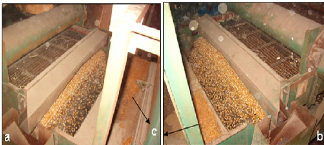
Figura 3 – Carga de operação das máquinas de pré-limpeza operando com milho. (a) recebe menor carga, (b) recebe maior carga, (c) soja como impureza de milho.
