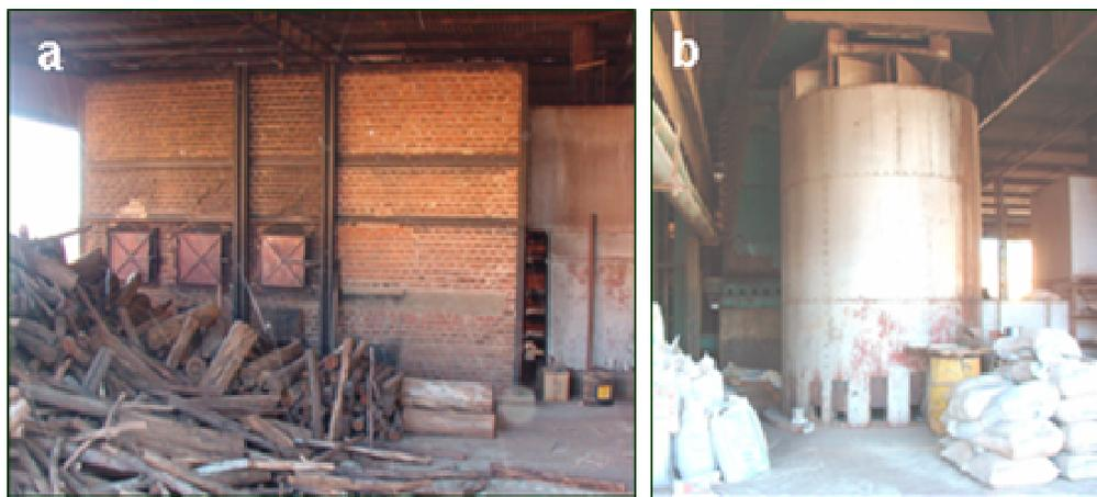
Figura 7 – Obstruções a tomada de ar na fornalha (a) e ciclone do sistema de secagem (b).
