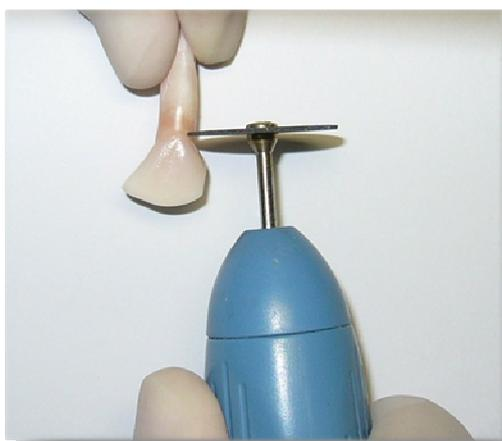
**Figura 1** – Secção da raiz dentária com disco de *carborundum*<sup>4</sup> em baixa rotação.
