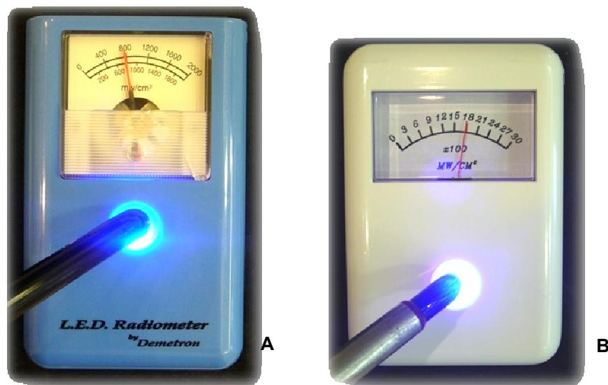
**Figura 13** – Radiômetros utilizados nas aferições dos fotopolimerizadores LED (A) e PAC (B).
