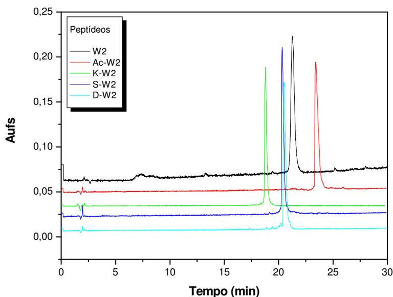
**Figura 10:** Perfis cromatográficos obtidos, após purificação, por HPLC dos peptídeos variantes da seqüência W2. Programa: 5-95 % B em 30 min. Solvente A: 0,045% TFA / H<sub>2</sub>O e B: 0,036% TFA . ACN. Fluxo de 1,5 mL e detecção em 220 nm.
