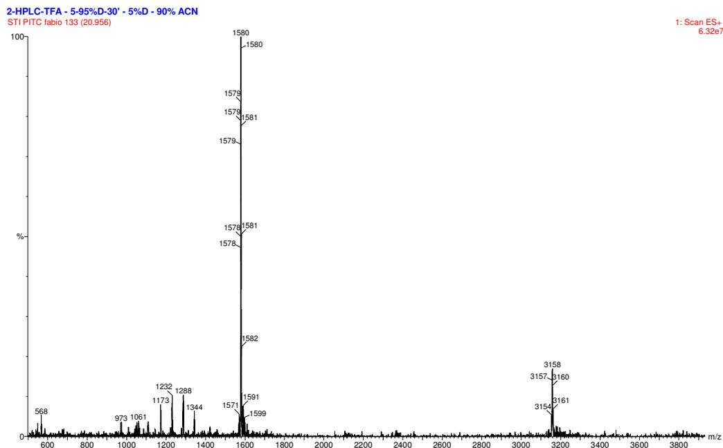
Figura 21: Espectro de massas obtido para o peptídeo puro St I 2-31 de peso molecular 3158 Da (carga +1), 1580 Da (carga +2).
