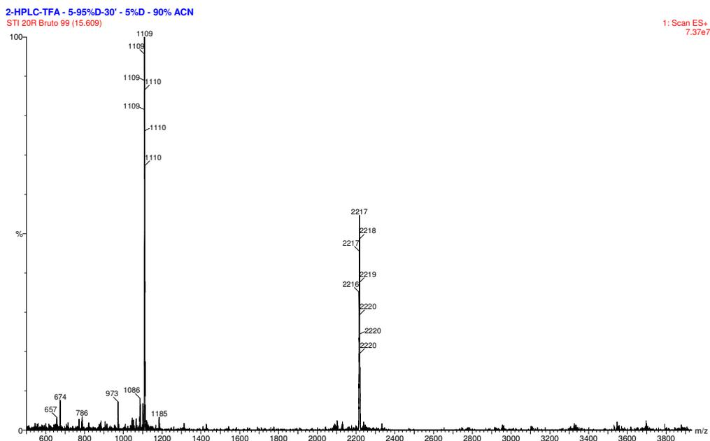
Figura 18: Espectro de massas obtido para o peptídeo puro St I 12-31 de peso molecular 2217 Da (carga +1), 1109 Da (carga +2).
