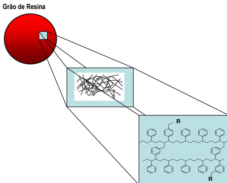
**Figura 5:** Visualização de um grão de resina, passando pelas cadeias poliméricas que a compõe até a formula molecular do poliestireno (MARQUARDT et al., 2001).
