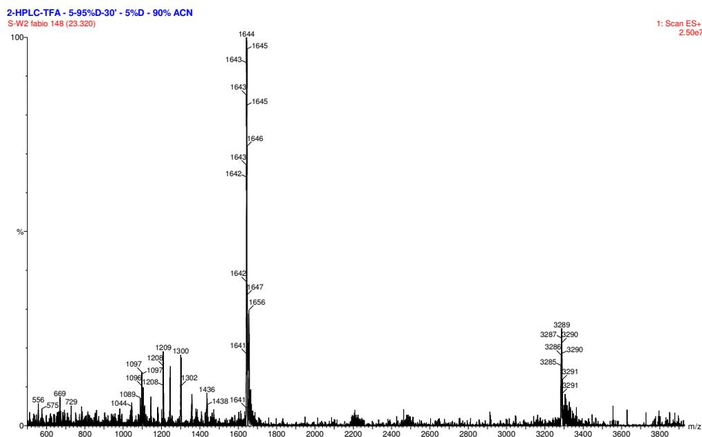
Figura 15: Espectro de massas obtido para o peptídeo puro S-W2 de peso molecular 3289 Da (carga +1), 1644 Da (carga +2) Da, 1096 Da (carga +3).
