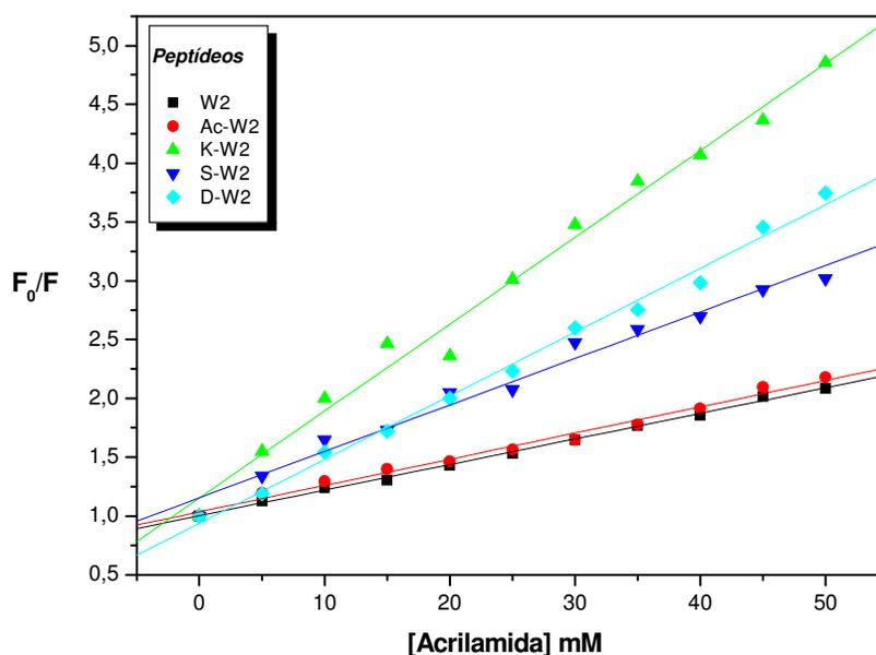
**Figura 44:** Variação dos valores de supressão de fluorescência  $F_0/F$  dos peptídeos em solução aquosa em função da concentração de acrilamida a pH [7,0], onde W2 (■), Ac-W2 (●), K-W2 (▲), S-W2 (▼), D-W2 (◆).
