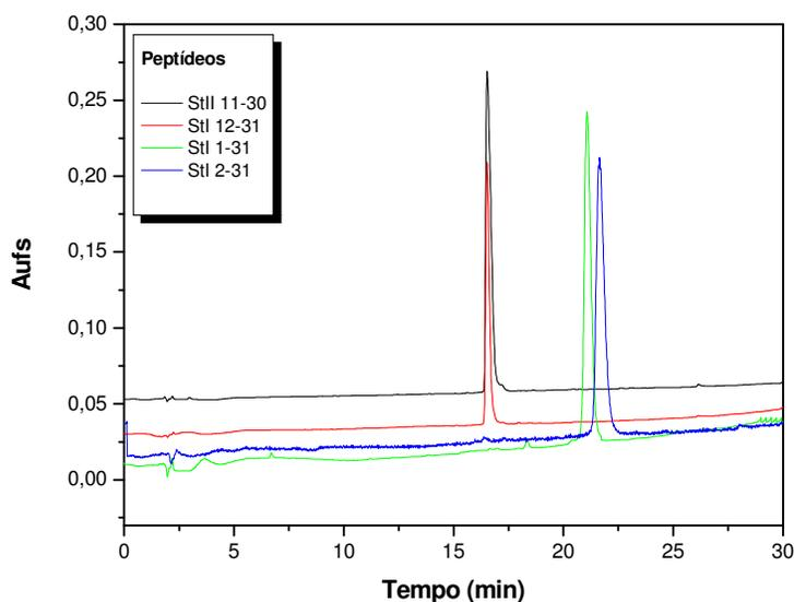
**Figura 11:** Perfis cromatográficos obtidos, após purificação, por HPLC dos peptídeos com 20 aminoácidos e do peptídeo St I 1-31. Programa: 5-95 % B em 30 min. Solvente A: 0,045% TFA . H<sub>2</sub>O e B: 0,036% TFA . ACN. Fluxo de 1,5 mL e detecção em 220 nm.
