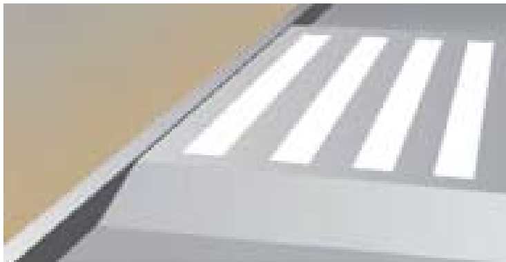
Figura 6.4: Travessia elevada (DENATRAN, 2000).
