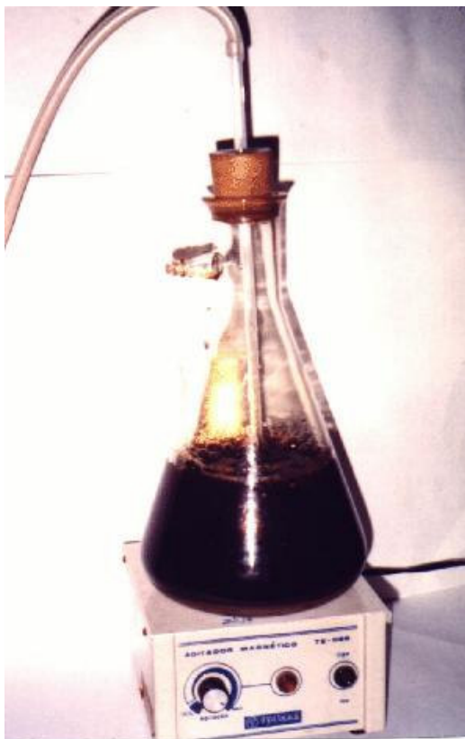
Figura 7 – Sistema utilizado na extração das substâncias húmicas de solo por procedimento em batelada.
