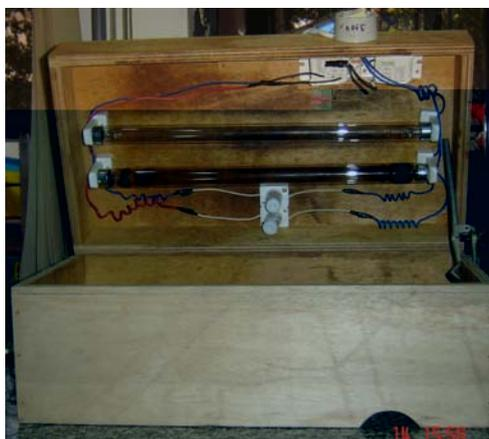
**FIGURA 3.2.** Sistema empregado para foto-Fenton artificial.
