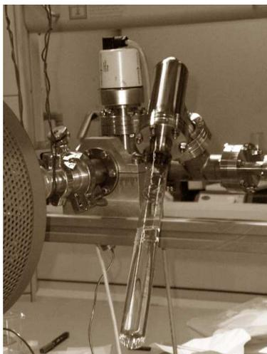
Figura 3.4: Sistema de CVD. A fonte precursora é mantida em um recipiente de pyrex-quartzo conectada com uma válvula tipo CF.
