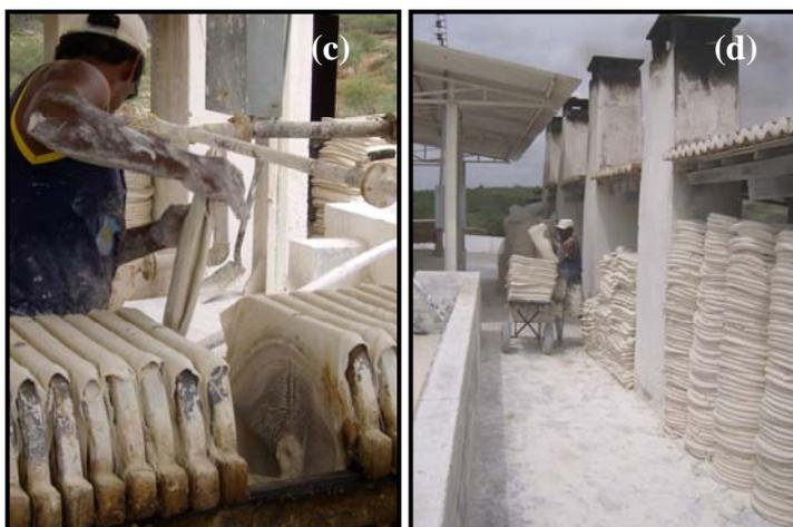
Fig. 2.6 – Caulim sendo passado no filtro-prensa (a) e (b), retirada dos blocos de caulim (c) e empilhamento para secagem (d).
