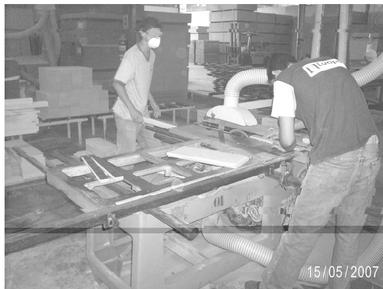
Figura 3.4: Vista da máquina de corte secundária sendo operada manualmente.
