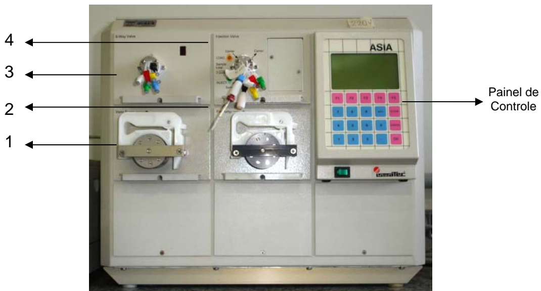
Figura 8. Foto do sistema de análise modular ASIA, Ismatec (Zurique, Suíça). Módulo 1: Bomba peristáltica de rotação variável; Módulo 2: Bomba peristáltica de rotação fixa; Módulo 3: Válvula de 6 caminhos, Rheodyne 5011; Módulo 4: Válvula de injeção Rheodyne 5041.
