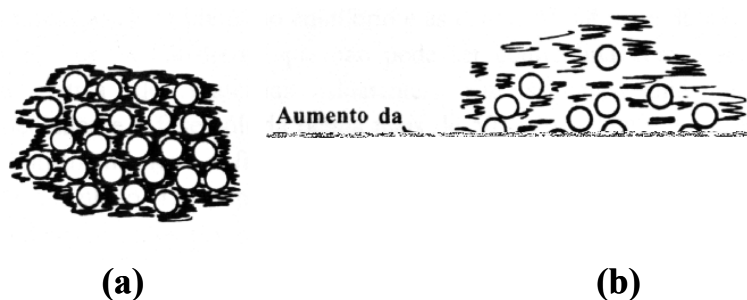
Figura II. 28. Explicação para o comportamento de um fluido dilatante; (a) antes e (b) após aplicação de uma velocidade de cisalhamento.
