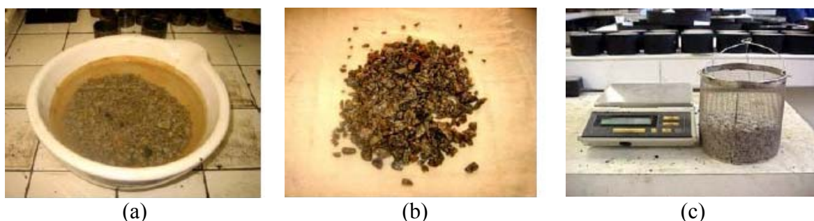
Figura 3.3: Algumas etapas do ensaio de densidade do agregado graúdo
